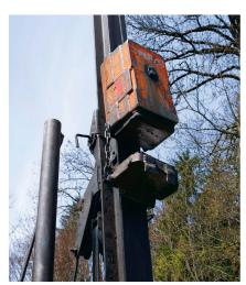
Der Ramm-Klotz wiegt 250 kg und erreicht pro Fallmeter ein Gewicht von einer Tonne.
