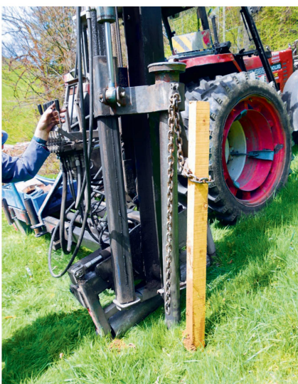
Mit dem «Auszieher» können Pfähle ohne grossen Aufwand ausgezogen werden.
