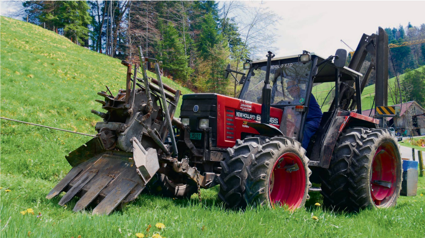
Im steilen Gelände sichert Blatter sein Gespann mit einer Seilwinde. Der Allrad-Traktor ist hinten und vorne mit Doppelrädern ausgerüstet.
