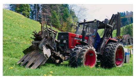
Im steilen Gelände sichert Blatter sein Gespann mit einer Seilwinde. Der Allrad-Traktor ist hinten und vorne mit Doppelrädern ausgerüstet.
