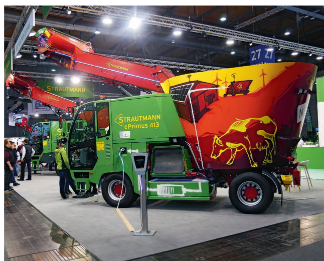
Soll 2024 auf den Markt kommen: der selbstfahrende Elektro-Futtermischer «EPrimus 413» von Strautmann. Vier Elektromotoren treiben Fräse, Mischer, Arbeitsfunktionen und Fahrantrieb an.
