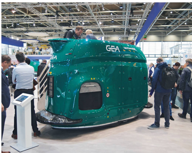
GEA zeigte seinen neuen Fütterungsroboter «DairyFeed F4500». Der Roboter fährt elektrisch und ist mit Navi-Sensoren ausgestattet, mit denen er die ideale Route zur Futterverteilung finden kann.
