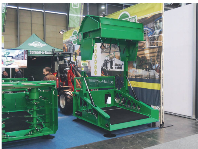
Ballenauflöser «Micro» von Spread-a-Bale für den Anbau an Hoflader. Der «Micro» ist neu, wiegt 695 kg und kann laut dem Hersteller von Hofladern ab 2,7 t Eigengewicht und ab 50 PS betrieben werden.
