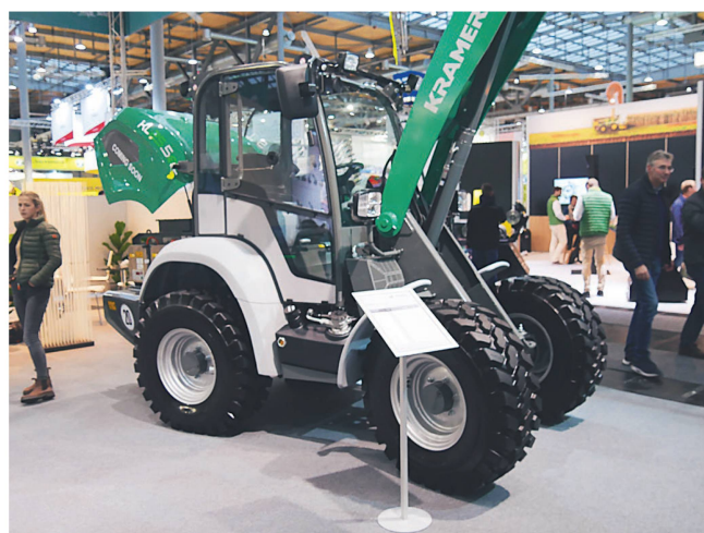
Der neue «KL25.5e» mit 96-Volt-Li-Ionen-Batterie wird bei Kramer die erste Generation E-Radlader ersetzen. Der Lader hat 1750 kg Stapelnutzlast und laut Kramer eine Laufzeit bis zu 4 Stunden.
