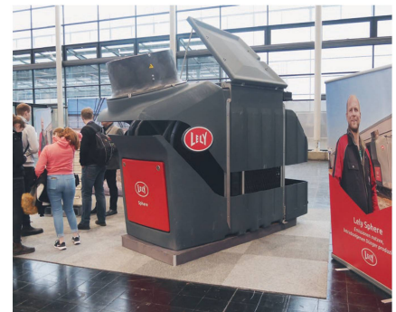
Lely «Sphere» trennt im Stall Mist vom Urin und wandelt die Stickstoffemissionen in wertvolle Düngemittel um.
