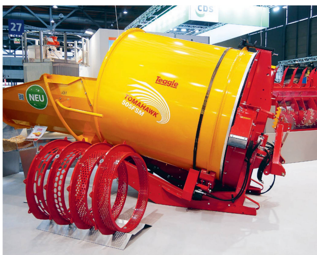
Strohmühle «Tomahawk 505M» für den Dreipunkt-Anbau von Hersteller Teagle (GB). Die Trommelverlängerung erleichtert das Beladen. Leistungsbedarf: ab 120 PS.
