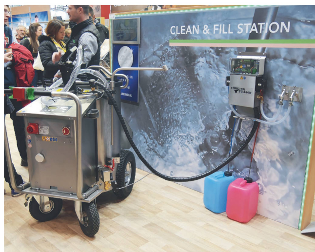
«Clean & Fill Station» von Förster reinigt vollautomatisch mobile Milchbehälter, befüllt den Behälter wieder mit Wasser und heizt dieses auf, so dass nur noch Milchpulver zugegeben werden muss.
