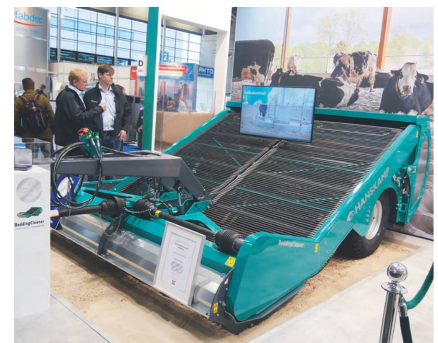
Mit dem «BeddingCleaner» von Hanskamp kann in Freilaufställen die Einstreu einfach und schnell vom Kot befreit werden.
