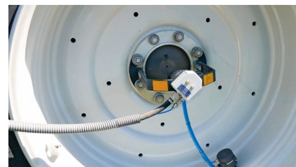
Optional ist eine Reifendruck-Regelanlage ab Werk verfügbar, die Valtra von PTG bezieht.
