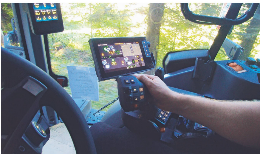
Das «SmartTouch»-Bedienkonzept umfasst das Standard-Display mit Fahrhebel an der Armlehne. Am A-Holm rechts befindet sich ein Display mit den Angaben zu den Betriebszuständen.
