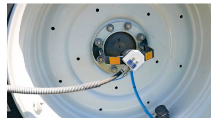
Optional ist eine Reifendruck-Regelanlage ab Werk verfügbar, die Valtra von PTG bezieht.
