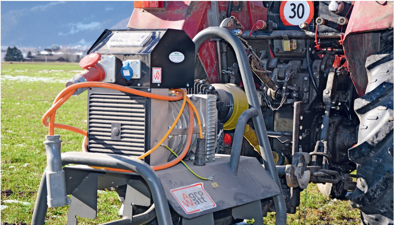
Der Zapfwellengenerator ist derzeit eine kostengünstige Variante für den Ersatzstrombetrieb einer PV-Anlage. Bild: R. Hunger
