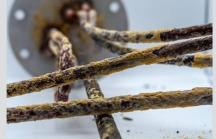
Verkalkte Boiler-Heizstäbe reduzieren die Heizleistung. Bild: Ralf Punkenhofer/Adobe Stock
