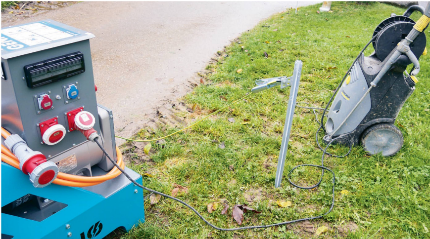
Im Feldbetrieb wird der Erdungsspiess so tief wie möglich in den feuchten Boden gerammt und mit dem Erdungskabel fest verbunden.
