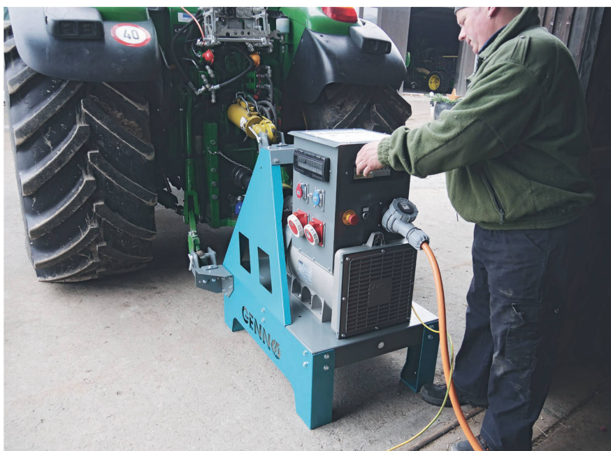
Mit einem Zapfwellengenerator ist es möglich, einen Betrieb mit Stall- und Wohngebäude bei Stromausfall mit genügend Elektrizität zu versorgen. Bilder: M. Abderhalden und R. Engeler
