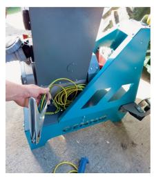
Mit diesem Kabel wird im Einspeisebetrieb über einen Blitzableiter abgesichert.
