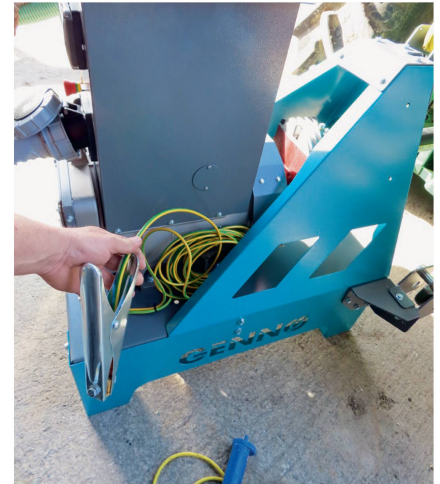
Mit diesem Kabel wird im Einspeisebetrieb über einen Blitzableiter abgesichert.
