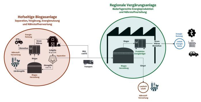
Beim NETZ-Konzept wird der Hofdünger in flüssige und feste Teile separiert. Die flüssigen Teile werden in kleinen Fermentern direkt auf den Höfen vergärt, während die festen Bestandteile in einer grossen regionalen Anlage verwertet werden. Die festen und die flüssigen Teile enthalten jeweils rund die Hälfte der Energie. Illustration: Schlussbericht VP NETZ
