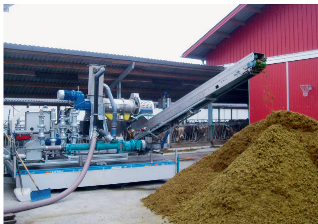
Mobile Anlage zur Auftrennung (Separierung) von Hofdünger in flüssige und feste Bestandteile. Bild: Jean-Louis Hersener
