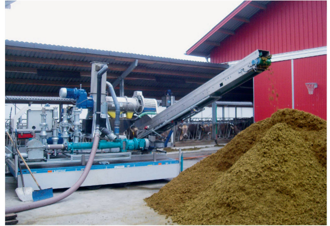
Mobile Anlage zur Auftrennung (Separierung) von Hofdünger in flüssige und feste Bestandteile. Bild: Jean-Louis Hersener
