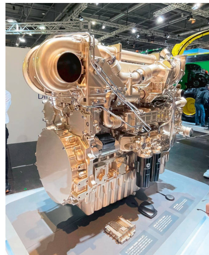
Der John-Deere-Motor «JD18X» verfügt über ein Abgasreinigungssystem ohne SCR und benötigt daher kein AdBlue.
