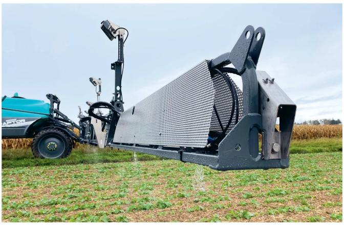
Ein mit dem Spot-Spraying-System «Sniper» ausgerüsteter Spritzbalken versprüht auf dieser Raps-Parzelle Spritzmittel punktgenau nach den vom Landwirt ausgewählten Einstellungen. Bilder: M. Schubnel
