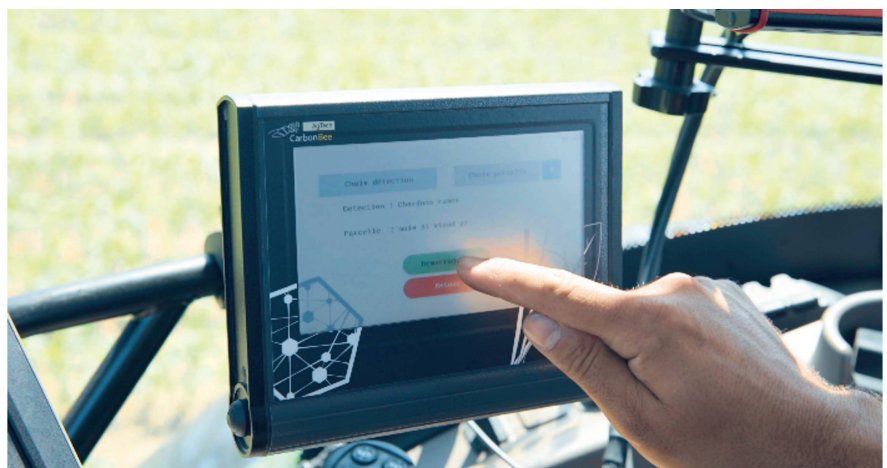
Via Terminal in der Kabine kann der Bediener zum Beispiel die gesamte eingescannte Fläche und die tatsächlich behandelte Fläche einsehen. Bild: Berthoud
