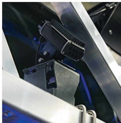
Zur Sima 2022 stellte Berthoud für das «Sniper»-System eine neue Kamera vor, die kompakter und leichter gebaut ist. Bild: Berthoud
