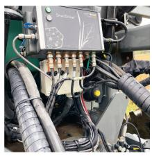
Ein Controller steuert das Öffnen jeder Düse mit einer Bearbeitungszeit von weniger als 200 Millisekunden.
