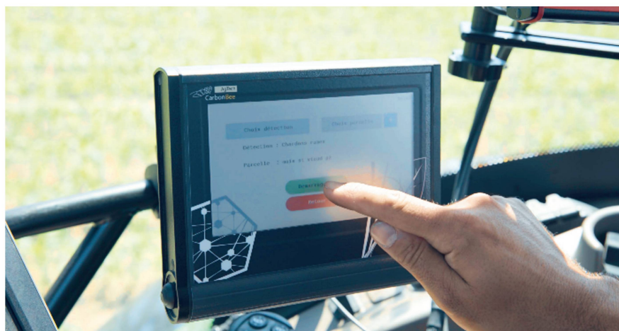
Via Terminal in der Kabine kann der Bediener zum Beispiel die gesamte eingescannte Fläche und die tatsächlich behandelte Fläche einsehen. Bild: Berthoud
