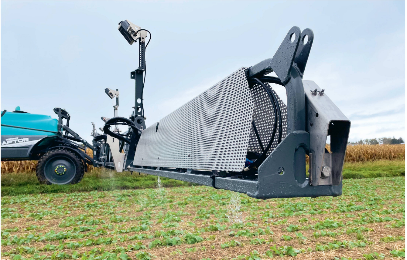
Ein mit dem Spot-Spraying-System «Sniper» ausgerüsteter Spritzbalken versprüht auf dieser Raps-Parzelle Spritzmittel punktgenau nach den vom Landwirt ausgewählten Einstellungen. Bilder: M. Schubnel
