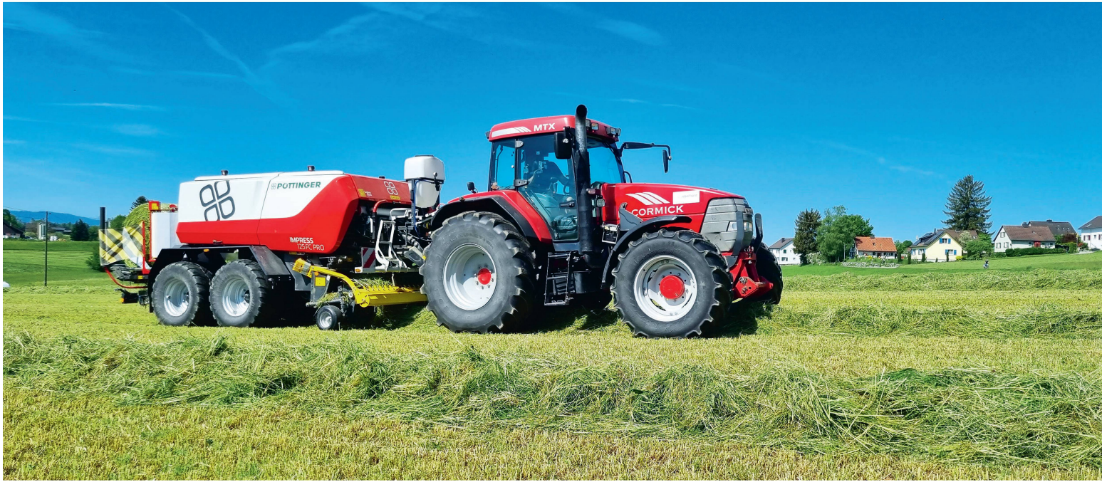
Pressen und Wickeln mit dem McCormick «MTX 110» an der «Impress 125FC PRO» von Pöttinger gehören zu den gängigsten Lohnarbeiten von Felix Eberhard aus Hombrechtikon ZH. Bild: Romy Widmer
