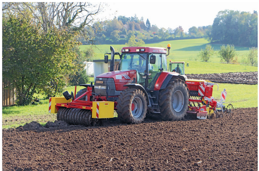
Kombiniertes Säen mit der mechanischen Aufbau-Sämaschine «Vitasem 302 A» von Pöttinger und Frontpacker. Bild: Romy Widmer
