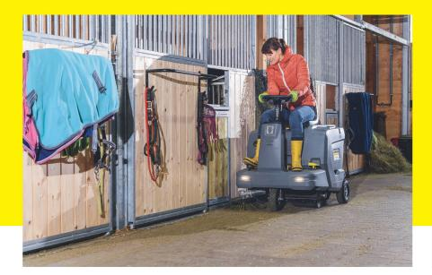
Grösse Flächen wie Stallgänge lassen sich mit einer Aufsitzkehrmaschine ohne körperliche Belastung deutlich schneller reinigen. Die Maschine sollte mit einem Seitenbesen ausgestattet sein, der auch die Ränder der Bodenflächen optimal reinigt.
