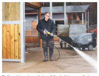
Die Nassreinigung kann mit einem Kalt- oder Heisswasser-Hochdruckreiniger durchgeführt werden.
