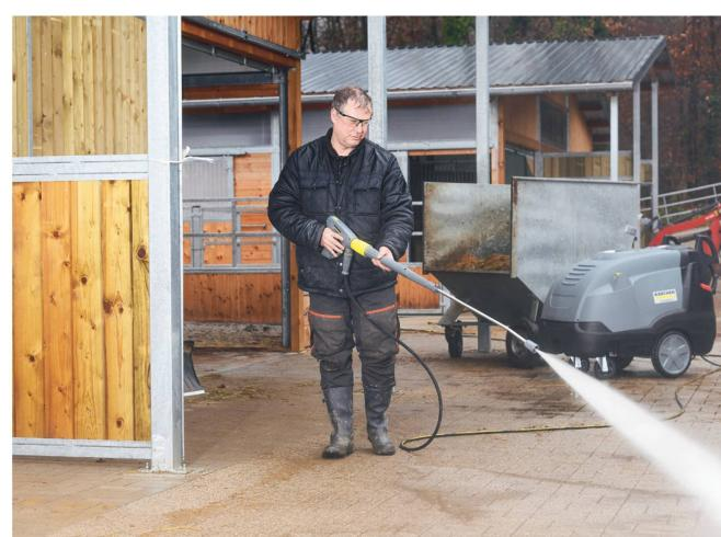
Die Nassreinigung kann mit einem Kalt- oder Heisswasser-Hochdruckreiniger durchgeführt werden.
