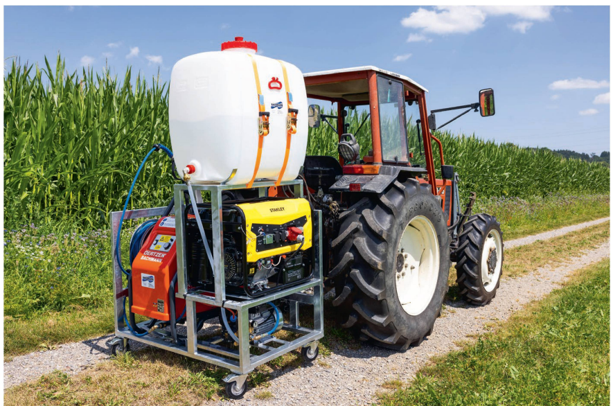
Dank dieses Projekts kann ein Traktor oder ein Agrarroboter über GPS zu einem Unkraut navigieren und es mit heissem Wasser behandeln.
