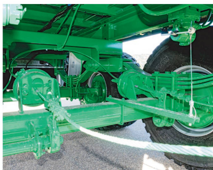
Der Fahrkomfort des Tandemfahrwerks wird durch eine verstärkte 3-Blatt-Parabel-Federung gewährleistet.
