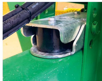
Serienmässig ist bei den «Agripush»-Wagen eine Deichselfederung mit zwei solchen Gummipuffern verbaut.
