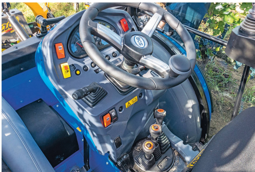
Die Hebel für die Getriebeschaltung sind mittig über dem Getriebetunnel angeordnet und verfügen über einen Druckknopf für die Kupplung.
