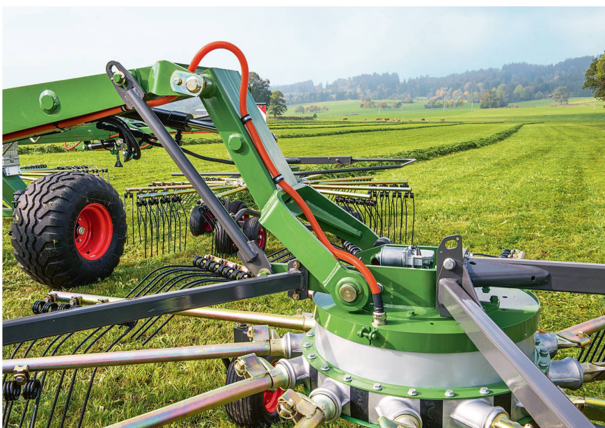
Vorausgesetzt, die elektrische Leistung reicht aus, können mit E-Aktuatoren auch Kreisel-schwader angetrieben werden. Bild: Fendt
