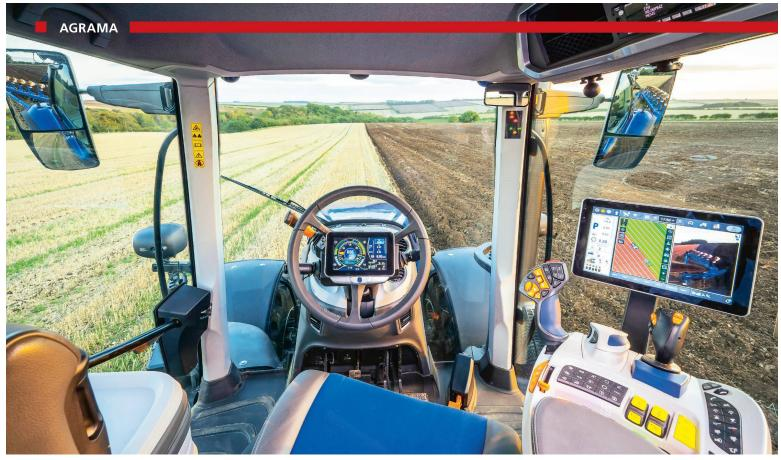
Die «Wohlfühlkabine» des «T7 HD» von New Holland mit einem feststehenden, digitalen Display im Lenkrad. Bild: New Holland
