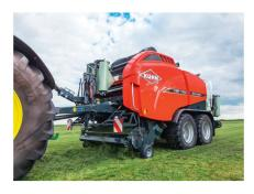
Press-Wickel-Kombi für Profis mit der einzigartigen Kuhn-«Twin-Reel»-Folienbindung.
