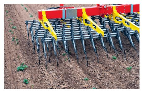
Stark im Rampenlicht: die mechanische Unkrautregulierung. Bild: Pöttinger
