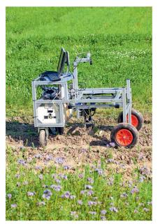
Entwicklungen von Funktionsmustern für die alternative Unkrautbekämpfung mit Laser (links, Projekt Caterra an der ETH Zürich) und Knallgas-Mikroflamme (rechts, Projekt Sportsweeder an der HAFL). Bilder: Aurel Neff und HAFL
