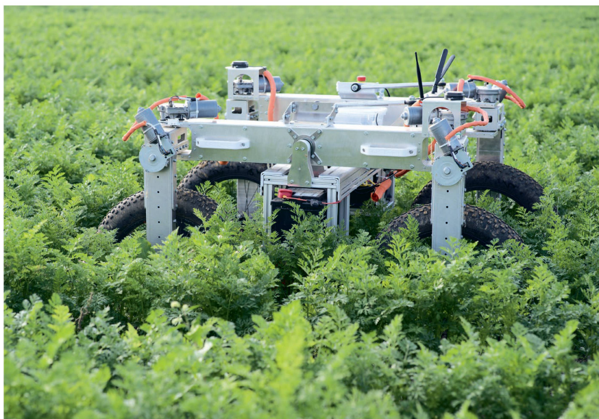
Entwicklungen von Funktionsmustern für die alternative Unkrautbekämpfung mit Laser (links, Projekt Cattera an der ETH Zürich) und Knallgas-Mikroflamme (rechts, Projekt Sportsweeder an der HAFL). Bilder: Aurel Neff und HAFL
