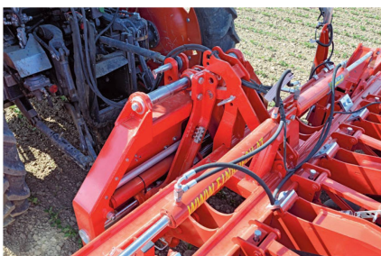
Wo grosse Kräfte übertragen werden, dominieren hydraulische Aktuatoren.
