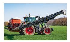
Der ROC-Bandschwader mit einzigartiger 6-reihiger Zinkenkonstruktion bietet viele Vorteile. Dank den versetzten Zinkenreihen mit den gebogenen Zinken wird das Futter besser aufgenommen, die Grasnarbe geschont und die Blattverluste werden minimiert.
