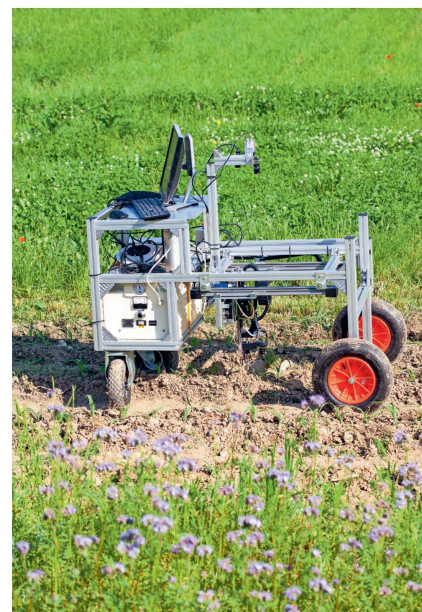
Entwicklungen von Funktionsmustern für die alternative Unkrautbekämpfung mit Laser (links, Projekt Cattera an der ETH Zürich) und Knallgas-Mikroflamme (rechts, Projekt Sportsweeder an der HAFL). Bilder: Aurel Neff und HAFL
