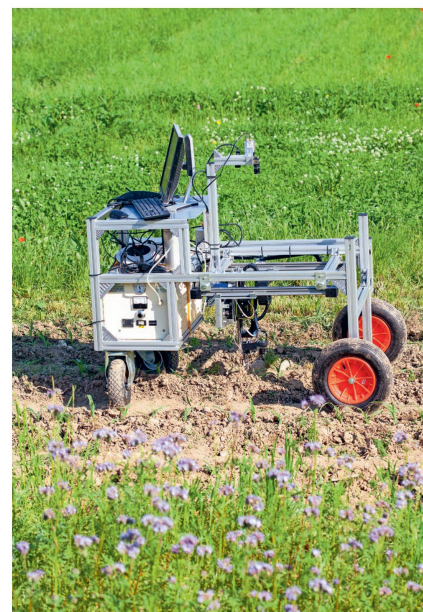
Entwicklungen von Funktionsmustern für die alternative Unkrautbekämpfung mit Laser (links, Projekt Cattera an der ETH Zürich) und Knallgas-Mikroflamme (rechts, Projekt Sportsweeper an der HAFL). Bilder: Aurel Neff und HAFL
