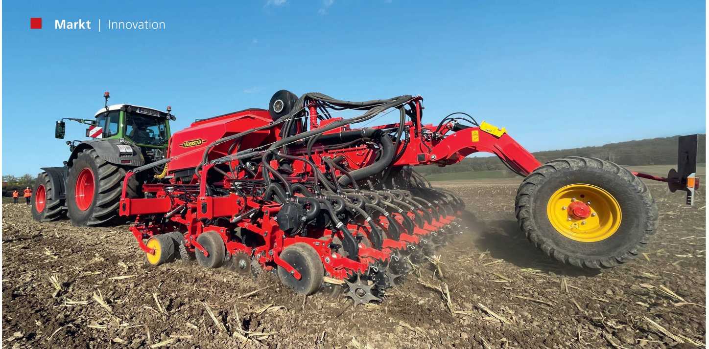
Die Väderstad «Proceed» ist für die meisten Kulturen geeignet. Vor der Ablage des Saatguts wird das Saatbett durch einzelne Vorlaufräder rückverfestigt, um gleiche Bedingungen für jedes Saatgut zu gewährleisten. Bilder: M. Schubnel
