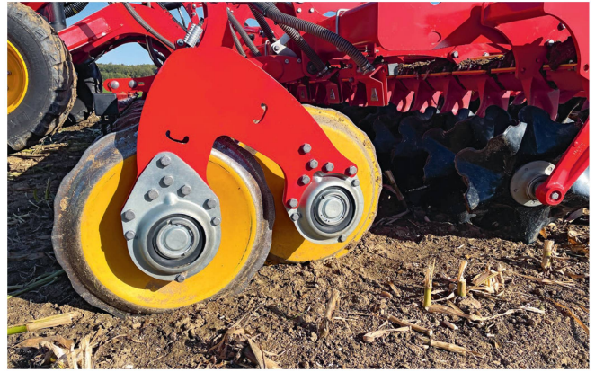
Jedes Lager der Väderstad-Geräte verfügt über einen Gummiaufhängungsring, der Stösse begrenzt und die Lebensdauer verlängert.
