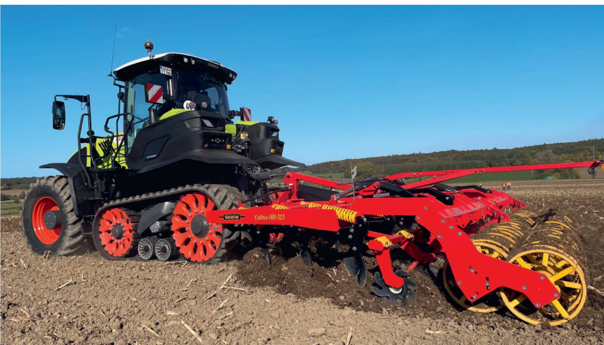
Der neue Zinkengrubber «Cultus HD» (hier das Modell «525») verfügt über eine mechanische Non-Stop-Sicherung mit einer Auslösekraft bis zu 680 kg.
