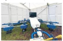
Schwader und einen Zetter in einem Gerät vereinigt. Er besitzt vier hydraulisch angetriebene Kreisel mit einem Durchmesser von 1,5 m. Das mitgeführte Hydraulikaggregat besitzt zwei Pumpen, die von einem Ölbehälter mit einem Volumen von 300 Litern versorgt werden. Die Maschine wird ab 2024 im Handel verfügbar sein.
