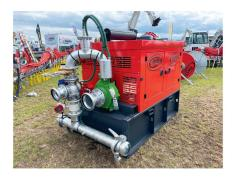
Dieselmotor der Marke Doosan treibt eine Güllepumpe Bauer «SX2000» mit einer Förderleistung von 227 m³/h bzw. 136 m³/h bei einer Förderhöhe von 200 m. Mit einem Schlauchquerschnitt von 150 mm kann die Gülle mit einem Aktionsradius von 2000 m verteilt werden. Die Produkte von Mastek werden in der Schweiz durch AgriDubey vertrieben.
