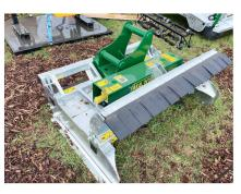
wickelt und besitzt zwei vertikale Rotoren, die mit je drei waagerechten Hackmessern arbeiten. Für die Arbeitsbreite von 1,43 m wird eine Hydraulikleistung von mindestens 80 l/min benötigt.
