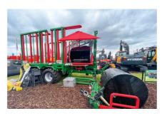
halbautomatisch weiterbefördert zu werden. Gesteuert wird er per Joystick und er kann bis zu 16 Ballen aufnehmen. Dank seinem hydraulischen Seitenarm und seinem Greifer zum Erfassen der Ballen wird nur ein Traktor und sein Bediener benötigt. Das Entladen erfolgt in zwei Schritten durch Kippen in die senkrechte Lage.
