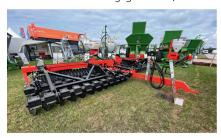
nen zweibalkigen Scheibengrubber mit einer Cambridge-Walze kombiniert. Optional kann das Gerät auch eine Sämaschine
