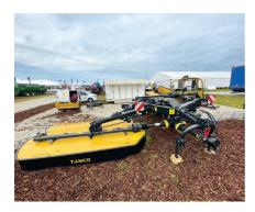
ähnlichen Konzept, die das Gras über eine Breite von 8,86 m mähen bzw. 9,79 m in Verbindung mit einem Frontmäher «M3» mit 2,80 m Schnittbreite. Die Produkte von Tanco werden durch Serco Landtechnik in die Schweiz importiert.
