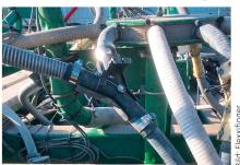
zu vereinfachen, bietet die kanadische Firma Flexxifinger das System «Multi Crop Valve» mit integrierten Luken an. Es handelt sich dabei um ein Y-förmiges Teil, das in den Pneumatik-Kreislauf integriert ist. Es soll dem Bediener bei sortenreinen oder bei Mischkultur-Saaten das mühsame Ab- und Umstecken der Saatgut-Transportleitungen oder des Düngers ersparen.
