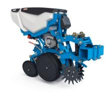
korn haften, bis dieses am Boden abgelegt wird. Die Saatgutablage wird so nicht durch Stösse oder andere Einflüsse gestört und soll eine höhere Arbeitsgeschwindigkeit erlauben. Monosem spricht von bis zu 18 km/h.
