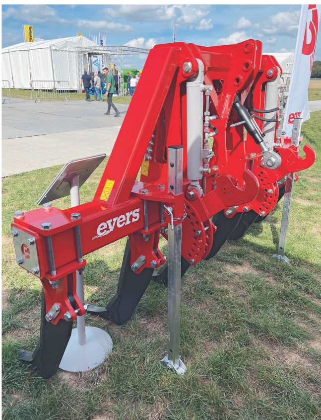
Links der Untergrundlockerer «Breton» von Evers in der 6-Zinken-Ausführung. Oben rechts der «Crown Crusher» von MSR Plant Technology, der das Kraut zerkleinert und damit das Wachstum hemmt. Unten rechts: der «VarioStriegel» von APV, der sich den Dämmen anpasst.
