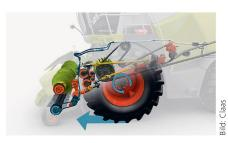
den Drehzahlen passen sich automatisch an Schnittlänge und Fahrgeschwindigkeit des Feldhäckslers an. Diese Entwicklung ist vorerst nur für die Modelle der Baureihe «Jaguar 900» optional erhältlich.
