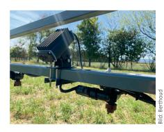
Schmutz auf den Kameras zu verhindern, können sich diese mit Hilfe eines integrierten Schaums selbst reinigen, indem sie kurzzeitig in ihr Gehäuse zurückkehren. Das Schutzgehäuse dient auch dazu, die Kameras bei der Transportfahrt zu schützen.
