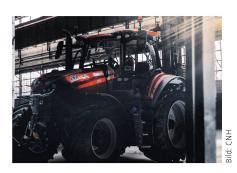
260» enthält eine Reihe von Funktionen aus der Serie «Optum». Der Traktor ist mit einer Kabine ausgestattet, welche die «AVS»-Option («Advanced Vehicle System») enthält. Dieses System verarbeitet alle Informationen von den hinteren und vorderen Hubwerken, von der Vorderachse sowie von der Kabinenfederung und sorgt so zusammen für eine Stabilisierung der Kabine. Dieses System soll später auch bei anderen Modellen der Baureihe «Puma» verfügbar werden.
