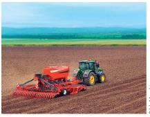
schiene ermöglicht mit bis zu 70 kg Schardruck eine exakte Aussaat auch bei hohen Geschwindigkeiten. Das Volumen des Tanks beträgt 5100 l. Ein Nachlauf-Striegel sorgt für den Abschuss der Saatarbeit.
