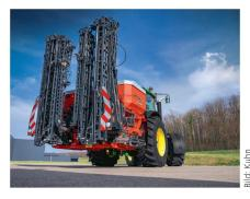
über 24 Düsen ausbringen. Die Dosierung erfolgt über Wiegesensoren. Wie bei den gezogenen pneumatischen Modellen kann die Gestängeausbreitung jetzt für alle Wetterbedingungen, einschliesslich Wind, programmiert werden. Eine optionale spezifische Dosierwalze eignet sich auch zum Ausbringen von Schneckenkorn oder zur Aussaat von Kleinsaaten. Für den Transport klappt das Gestänge senkrecht hinter den Behälter.
