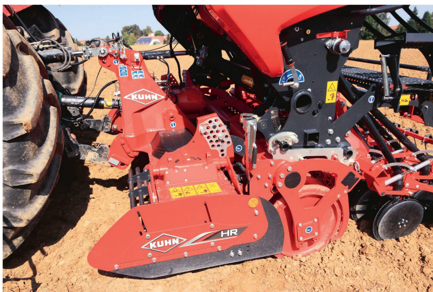
Die «Sitera 3030e» ist per Schnellverschluss auf der Walze montiert. Die Kreiselegge leistete gute Dienste.
