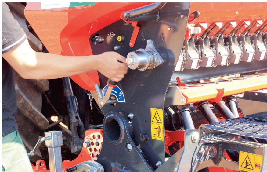
An der linken Seite lässt sich das Fördervolumen der Zellenräder mit der grossen Einstellschraube justieren.
