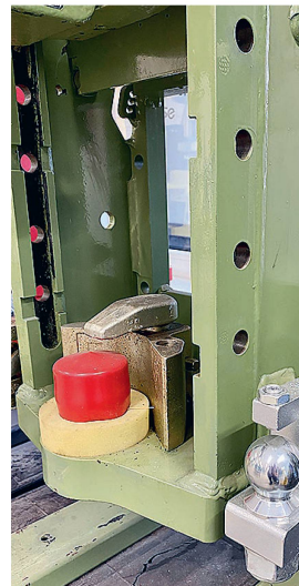
Anhängebock mit genormten Befestigungspunkten für Zwangslenkung.
