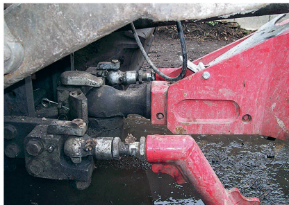
Beispiel für eine Zwangslenkungsanwendung. Bilder: Walterscheid
