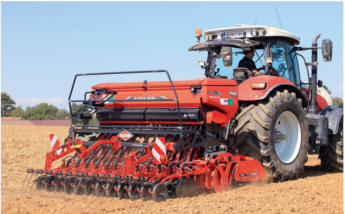
Die Sämaschine «Sitera 3030e» mit elektrischem Antrieb ist das Topmodell unter den mechanischen Sämaschinen von Kuhn. Bilder: L. Weninger
