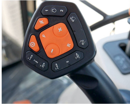
Der Ganghebel ist als Multifunktionsgriff konzipiert.
