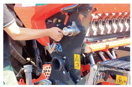
An der linken Seite lässt sich das Fördervolumen der Zellenräder mit der grossen Einstellschraube justieren.
