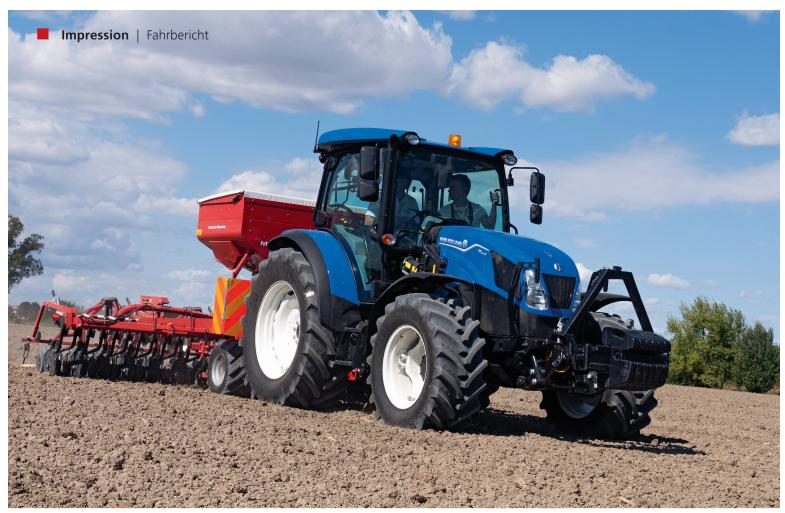
Einfach, aber zweckmässig und in Sachen «Smart Farming» ausbaubar: Der New Holland «T5.100S» im Einsatz mit einer Sä-Kombination unter Verwendung von Section-Control. Bilder: R. Engeler
