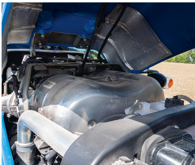
Die Abgasnorm der Stufe 5 wird durch das kompakte und wartungsfreie, unter der Motorhaube platzierte «Hi-eSCR2»-System erreicht.
