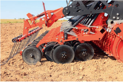
Das «Seedflex»-Scharsystem leistete sehr gute Arbeit, nur das Verstellen des Schar-drucks ist etwas umständlich.
