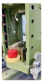
Anhängebock mit genormten Befestigungspunkten für Zwangslenkung.
