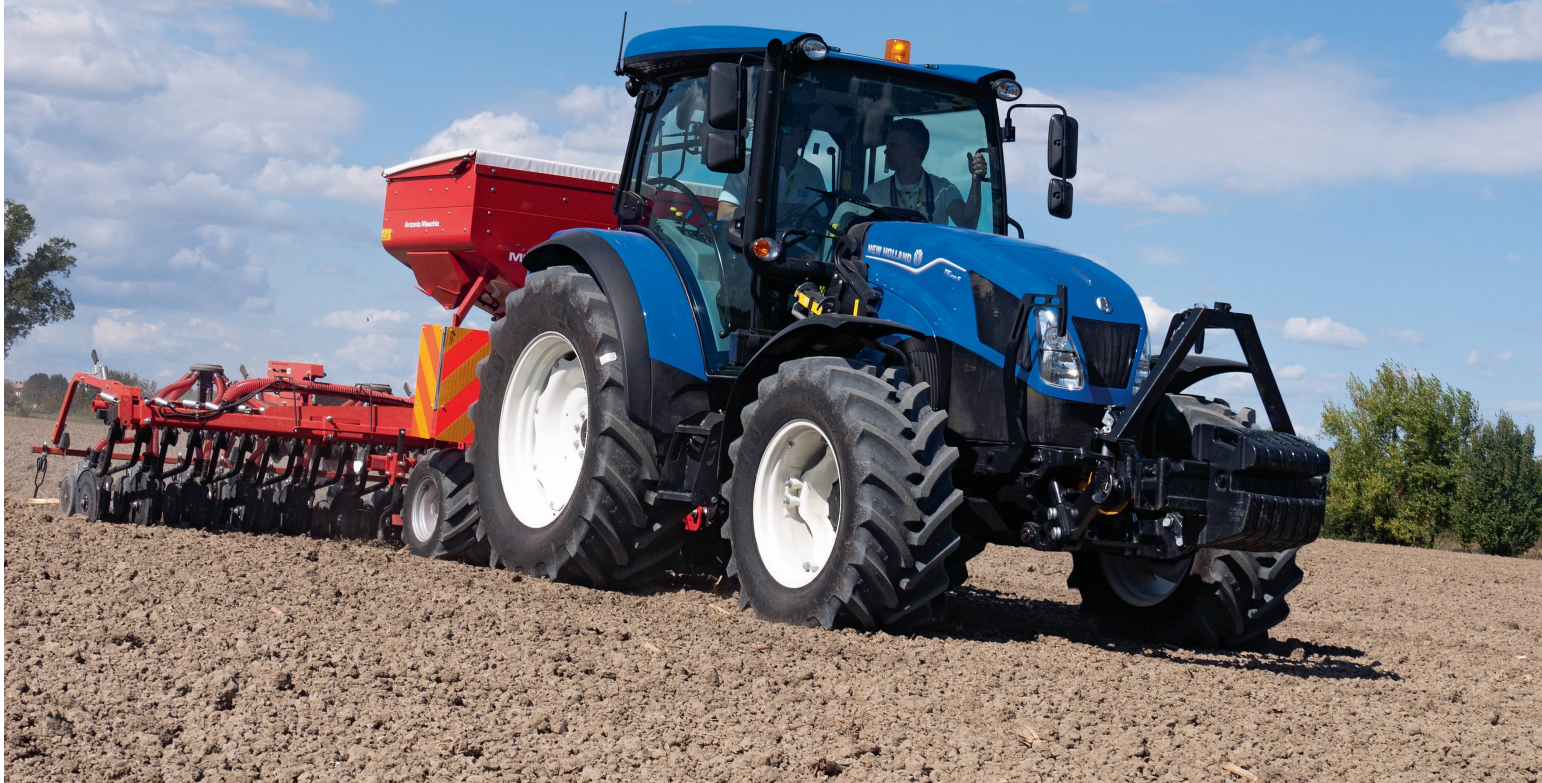
Einfach, aber zweckmässig und in Sachen «Smart Farming» ausbaubar: Der New Holland «T5.100S» im Einsatz mit einer Sä-Kombination unter Verwendung von Section-Control. Bilder: R. Engeler
