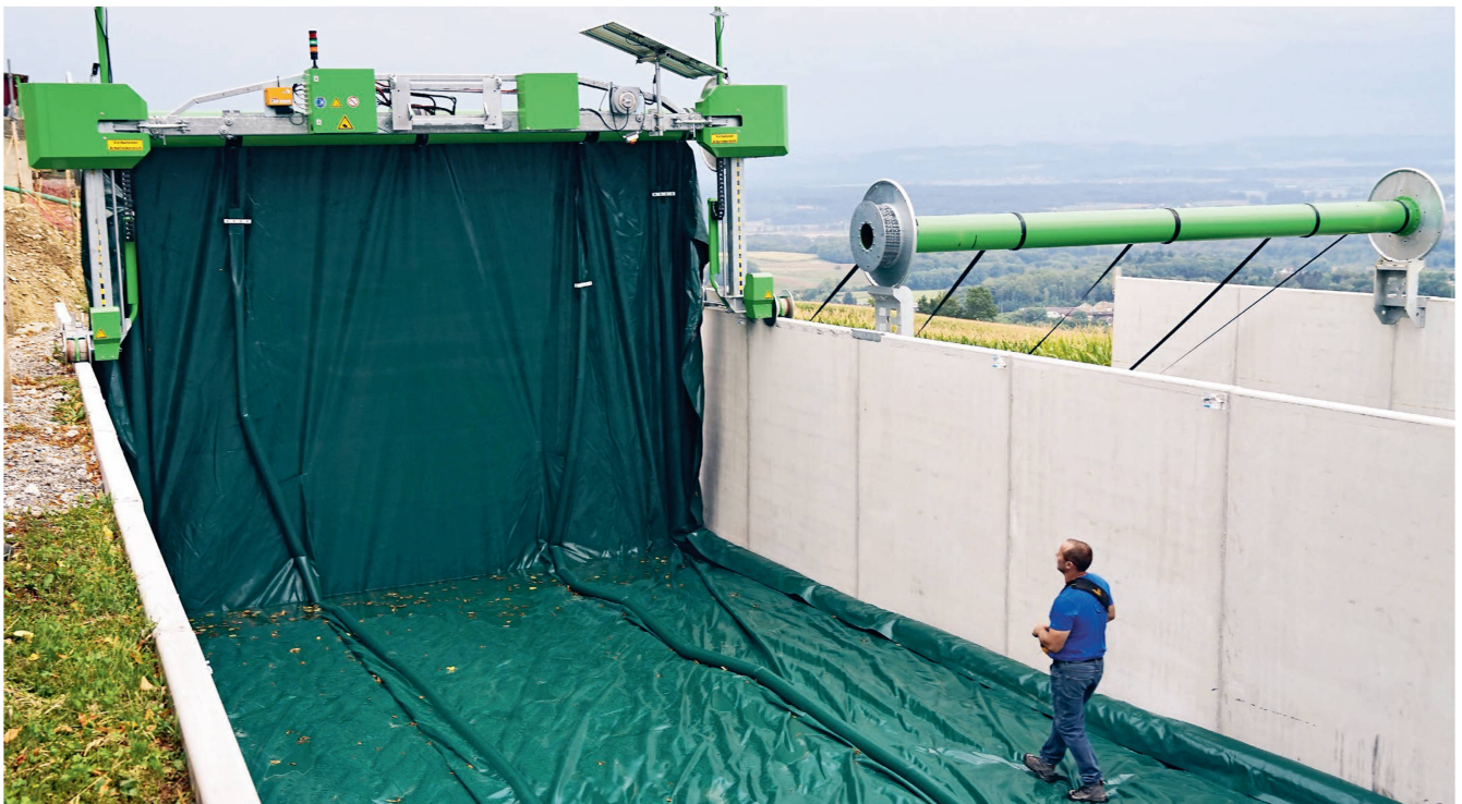
Das Abdecksystem mit Solarpanel, Elektromotoren und Haspel rollt auf den Mauerkronen vorwärts und das überschüssige Wasser fliesst nach und nach zurück. Rechts beim zweiten Fahrsilo der Haspel ohne Aufrollsystem. Bilder: D. Senn
