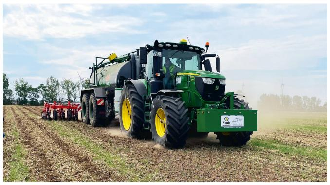
Renaissance der Gülle: Direkt vor der Maisaussaat wird sie in Bändern etwa 12 cm tief in den Boden eingebracht. Bilder: M. Schubnel
