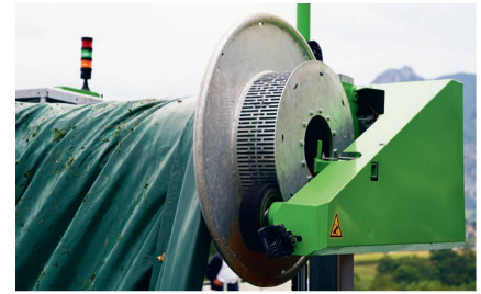
Die Kraftübertragung vom Aufrollsystem auf den Haspel.
