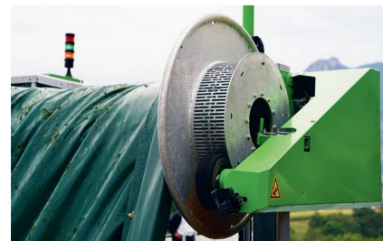
Die Kraftübertragung vom Aufrollsystem auf den Haspel.
