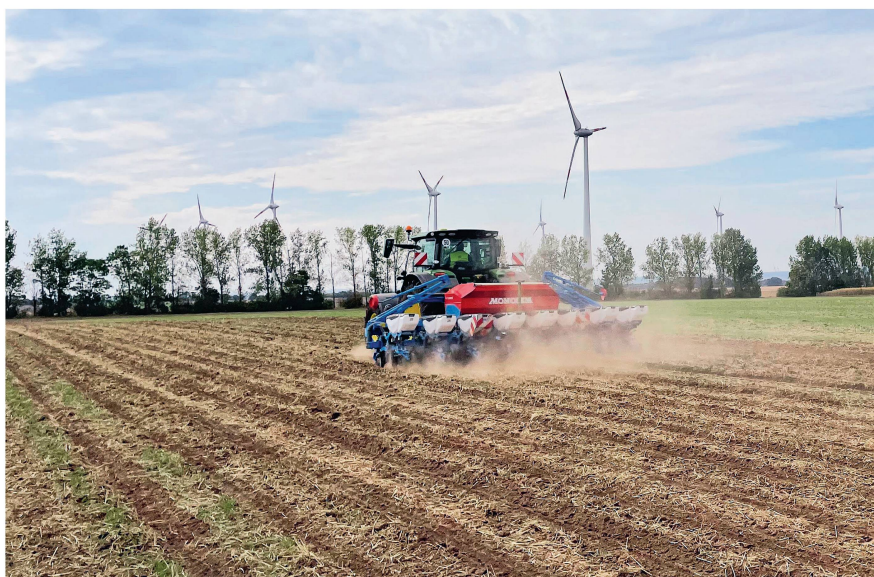
Auch bei unregelmässigen Schlägen und Kurvenfahrten werden laut Hersteller die Saatkörner immer exakt über dem Gülleband abgelegt.
