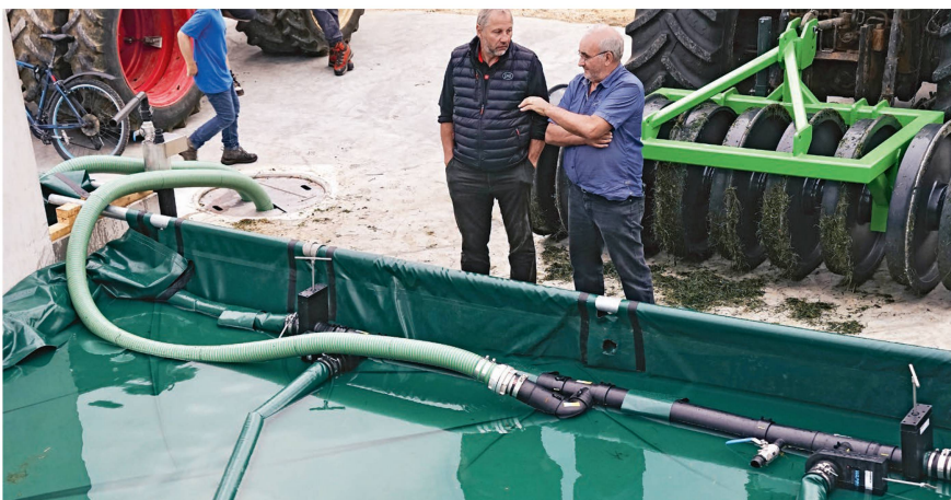
Am Fussende sind die Schläuche zusammengeschlossen und an den Wassertank sowie an das Füllgerät (ein Überlaufsystem mit integriertem Fühler) angehängt.
