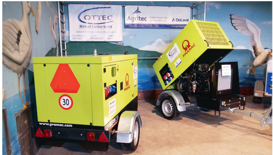
Auf vielen Betrieb kann ein Inselbetrieb mit Notstrom-Aggregaten eingerichtet werden, sofern eine galvanische Trennung zwischen Stromnetz und der Inselanlage geschaffen wird.
