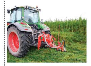
ge der beiden Pflanzenteile passend eingestellt werden. Die verwendeten Bidux-Messerbalken mit ungleicher Klingenteilung 70/84 mm und gezahnten Carbodux-Messerklingen sollen einen sauberen Schnitt garantieren. Die Doppelmessermähwerke werden hydraulisch angetrieben und benötigen zusammen etwa 37 kW/50 PS Leistung.
