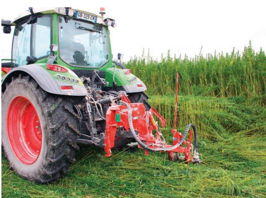
Die verwendeten Bidux-Messerbalken mit ungleicher Klingenteilung 70/84 mm und gezahnten Carbodux-Messerklingen sollen einen sauberen Schnitt garantieren. Die Doppelmessermähwerke werden hydraulisch angetrieben und benötigen zusammen etwa 37 kW/ 50 PS Leistung.
