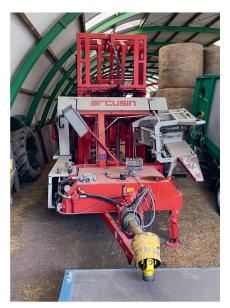
Die Ballenpresse Arcusin «B14» presst mehrere Kleinballen zu einer einzigen grossen Balle.
