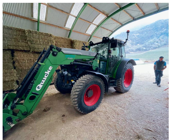
Für die Lieferungen auf abgelegenen, teils vereisten Strassen kommt ein Fendt «211 Vario» mit Spike-Industriebereifung zum Einsatz.
