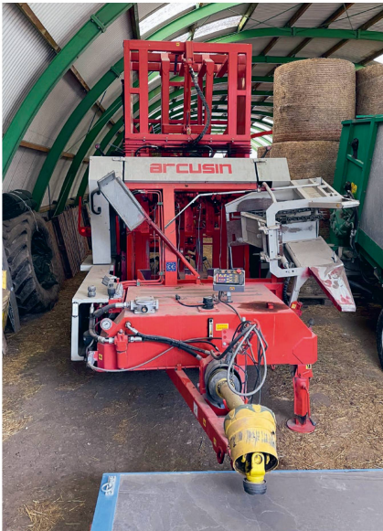
Die Ballenpresse Arcusin «B14» presst mehrere Kleinballen zu einer einzigen grossen Balle.
