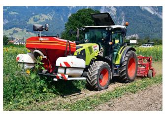
Mit dem Geohobel von Flurin Frigg aus Pratval gelang es, den dichten Gründüngungsbestand flach einzuarbeiten.
