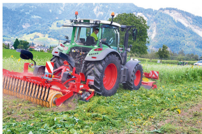
Die Horsch-Messerwalze an der Front leistete die Vorarbeit für die im Heck angebaute Väderstad-Scheibenegge mit «CrossCut»-Scheiben.
