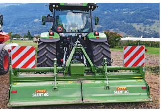
Die Celli-Bodenfräse mit Winkelmesser hatte wenig Mühe, die Pflanzen zu zerhacken und mit Erde zu überdecken.
