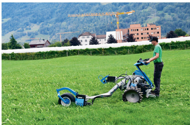
Gezeigt wurden auch Motormäher mit Doppelmesserbalken wie hier ein Brielmaier mit «Bidux»-Doppelmesser.
