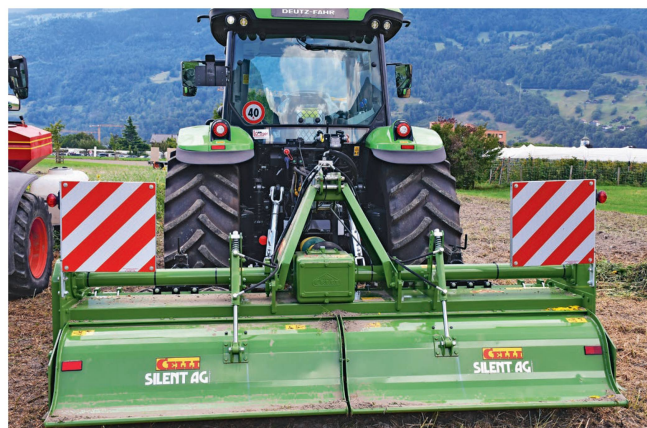
Die Celli-Bodenfräse mit Winkelmesser hatte wenig Mühe, die Pflanzen zu zerhacken und mit Erde zu überdecken.
