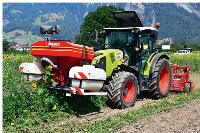
Mit dem Geohobel von Flurin Frigg aus Pratval gelang es, den dichten Gründungsbestand flach einzuarbeiten.
