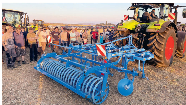
Lemken «Karat 9»: Der bewährte Intensivgrubber zeichnet sich durch einen grossen Freiraum zwischen den drei Zinkenreihen, zwischen den Zinken und unter dem Rahmen aus. Das Gerät eignet sich sowohl für die erste flache und ganzflächige Stoppelbearbeitung nach dem Mähdrusch als auch für die nachfolgenden tieferen und intensiv mischenden Arbeitsgänge.
