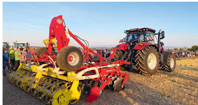
Pöttinger «Terradis 5001 T»: Diese imposante, gezogene Kurzscheibenegge verfügt über zwei Reihen gezackter Scheiben, einen Striegel und war für die Präsentation mit einer Tandemwalze des Typs «Cornoroll» ausgestattet. Die Arbeitsbreite beträgt 5 m, das Gewicht liegt bei 6 t.
