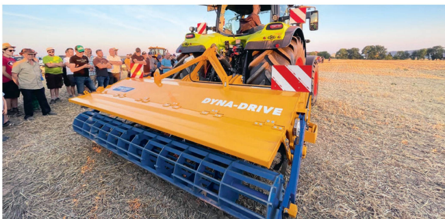
Bomford «Turner Dyna-Drive»: Diese 3 m breit arbeitende Bodenfräse verfügt über zwei Zinkenrotoren. Der erste Rotor gräbt die Erde auf und wirft sie auf den zweiten Rotor. Die empfohlene Arbeitsgeschwindigkeit beträgt 8 bis 12 km/h bei einer Flächenleistung von 3,5 bis 4 ha/h. Diese vielseitige Maschine benötigt 130 bis 140 PS Zugkraft.
