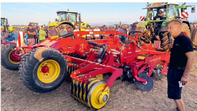
Väderstad «Carrier XL 425»: Diese gezogene Scheibenegge war mit einer vorlaufenden Messerwalze ausgestattet, welche die Ernterückstände zerkleinert. Die Scheiben haben Durchmesser von 450 bis 600 mm (hier waren sogenannte «CrossCutter»-Scheiben montiert). Das Gerät arbeitet eher flach. Die nachlaufende Walze sorgt für eine Rikverfestigung.
