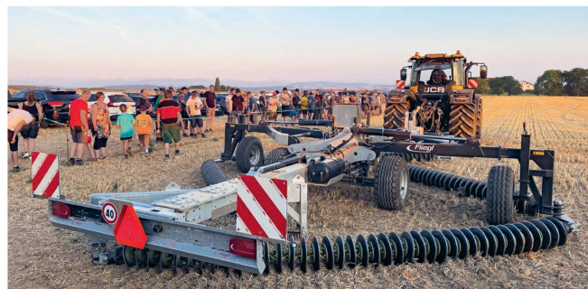
Fliegl «KSE 680»: Die aufgesattelte Kettenscheibenegge ist mit vier Reihen von Kultivierungsscheiben bestückt, die im Rautenmuster angeordnet sind. Die Arbeitstiefe liegt zwischen 4 und 10 cm. Gefahren wird bei einer Geschwindigkeit von 12 bis 18 km/h. Anstellwinkel und Spannung der Ketten lassen sich einstellen.
