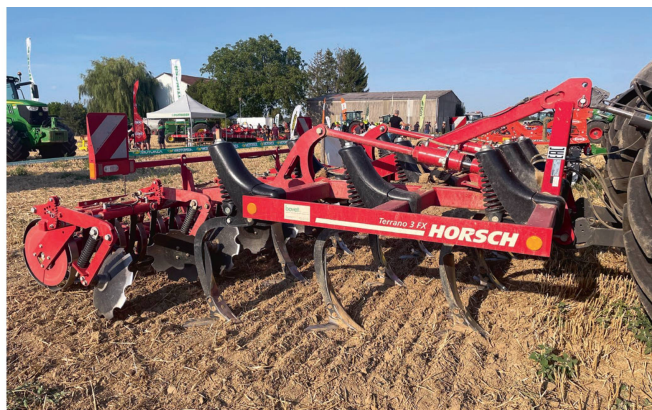
Horsch «Terrano 3 FX»: Dieser dreibalkige, leichtzügige und kompakte Universalgrubber, der sich sowohl zur flachen Stoppelbearbeitung als auch für eine intensive Lockerung und Mischung eignet, wurde mit «TerraCut»-Scharen, mit nachlaufenden Scheiben und einer «RollFlex»-Walze eingesetzt.
