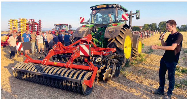
Kuhn «Optimer XL 300»: Diese Kurzscheibenegge verfügt über zwei Reihen mit einzeln aufgehängten Scheiben (Durchmesser 620 mm). Es können Arbeitstiefen zwischen 5 und 15 cm bearbeitet werden. Dank der grossen Scheiben ist die Verstopfungsgefahr gering. Das Gerät kann auch nach der Ernte von Körnermais eingesetzt werden.
