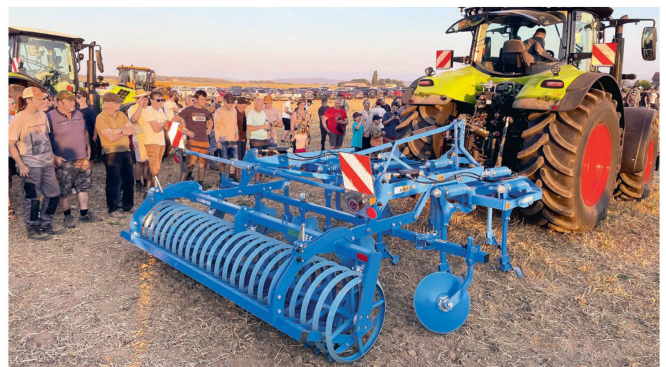
Lemken «Karat 9»: Der bewährte Intensivgrubber zeichnet sich durch einen grossen Freiraum zwischen den drei Zinkenreihen, zwischen den Zinken und unter dem Rahmen aus. Das Gerät eignet sich sowohl für die erste flache und ganzflächige Stoppelbearbeitung nach dem Mähdrusch als auch für die nachfolgenden tieferen und intensiv mischenden Arbeitsgänge.
