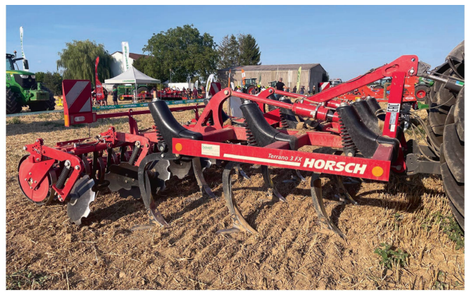
Horsch «Terrano 3 FX»: Dieser dreibalkige, leichtzügige und kompakte Universalgrubber, der sich sowohl zur flachen Stoppelbearbeitung als auch für eine intensive Lockerung und Mischung eignet, wurde mit «TerraCut»-Scharen, mit nachlaufenden Scheiben und einer «RollFlex»-Walze eingesetzt.
