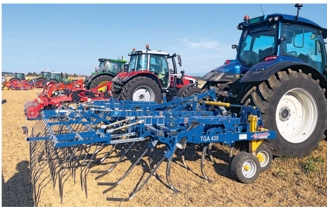
Treffler «TGA 430»: Der Präzisionsgrubber arbeitet flach auf einer Breite von 4,30 m. Er verfügt über drei Zinkenreihen, die sich in einem Bereich von 8 cm überlappen, kombiniert mit Einebnungszinken und einem Striegel. Zwei Tandemräder steuern die Arbeitstiefe. Die erforderliche Leistung des Zugfahrzeugs liegt bei rund 120 PS.
