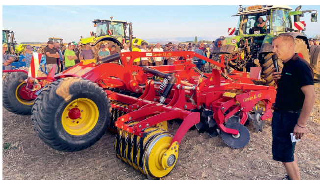
Väderstad «Carrier XL 425»: Diese gezogene Scheibenegge war mit einer vorlaufenden Messerwalze ausgestattet, welche die Ernterückstände zerkleinert. Die Scheiben haben Durchmesser von 450 bis 600 mm (hier waren sogenannte «CrossCutter»-Scheiben montiert). Das Gerät arbeitet eher flach. Die nachlaufende Walze sorgt für eine Rückverfestigung.
