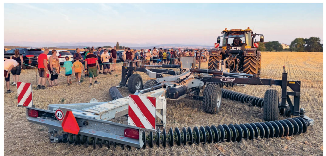
Fiegl «KSE 680»: Die aufgesattelte Kettenscheibenegge ist mit vier Reihen von Kultivierungsscheiben bestückt, die im Rautenmuster angeordnet sind. Die Arbeitstiefe liegt zwischen 4 und 10 cm. Gefahren wird bei einer Geschwindigkeit von 12 bis 18 km/h. Anstellwinkel und Spannung der Ketten lassen sich einstellen.
