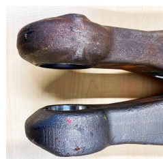
Vergleich der Zugösen DIN 11026 (rechts) und DIN 74053 (ganz rechts).
