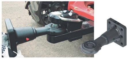
Die Schwenklager-Zugöse: Bolzen und Zugöse haben denselben Durchmesser. Das vermindert Spiel zwischen Öse und Bolzen und vemindert kleine «Schläge» bei der Fahrt.
