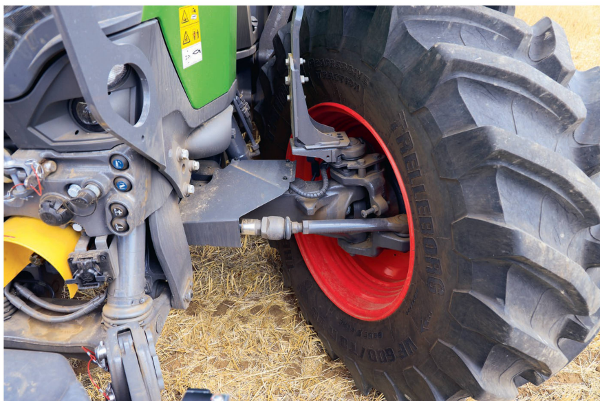
Der Lenkeinschlag misst 52°. Da die Vorderräder dank «VarioDrive»-Getriebe quasi in die Kurve gezogen werden, resultiert ein Wenderadius von 10 m.
