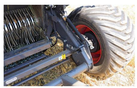
Der neue Fahrwerksrahmen ermöglicht grössere Räder für mehr Bodenschonung.
