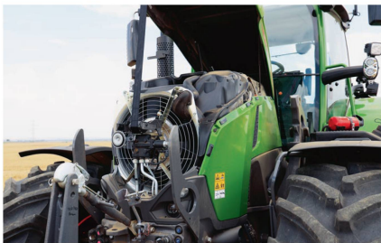
Verbaut wird ein neuer 7,5-l-Motor von Agco Power mit hydraulisch angetriebenem, drückendem Lüfter.
