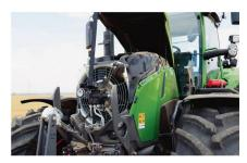
Verbaut wird ein neuer 7,5-l-Motor von Agco Power mit hydraulisch angetriebenem, drückendem Lüfter.
