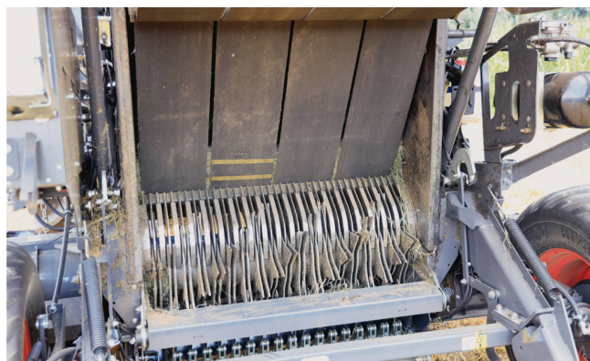
Der neue 17-Messer-Schneidrotor hat eine theoretische Schnittlänge von 60 mm.
