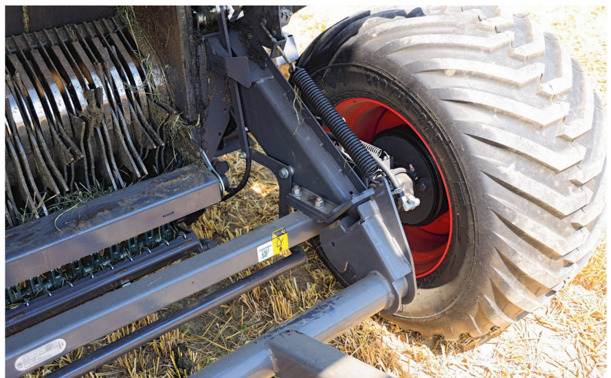
Der neue Fahrwerksrahmen ermöglicht grössere Räder für mehr Bodenschonung.
