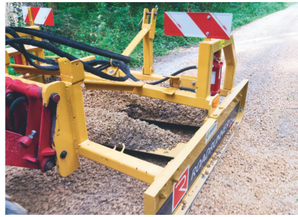
Zwei leicht angewinkelte Schürfleisten planieren das aufgeschürfte Material auf der gesamten Arbeitsbreite.
