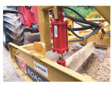
Über zwei Hydraulikzylinder kann die Bearbeitungstiefe links und rechts verstellt werden.
