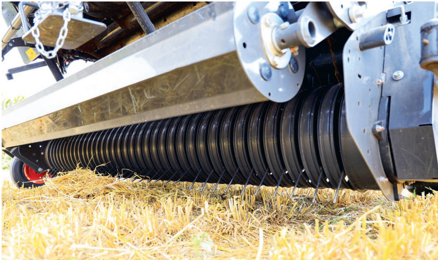
Das 2,35 m breite Pickup (Option) weist vier gesteuerte Zinkenreihen auf.
