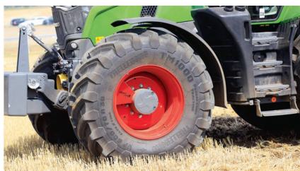
Die Reifendruckregelanlage «VarioGrip» ist integriert und kann von der Kabine aus gesteuert werden.
