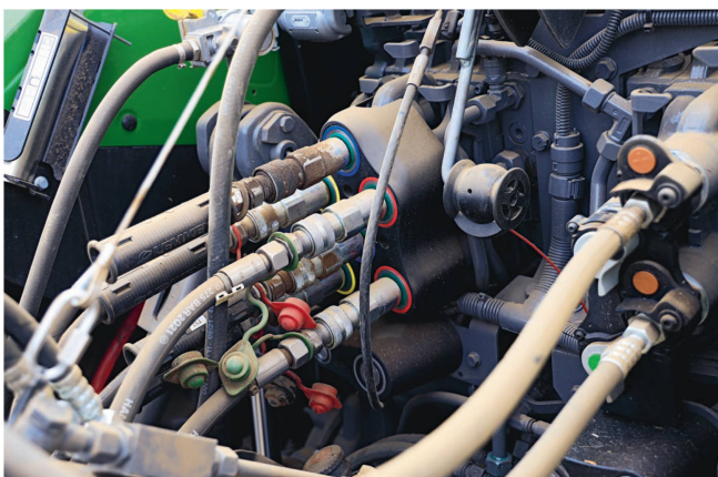
Bei den Steuerventilen sind flach dichtende und leckagefreie Kupplungen Standard.
