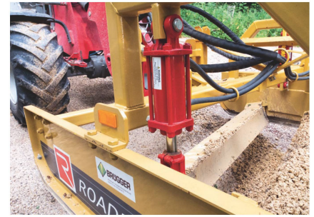
Über zwei Hydraulikzylinder kann die Bearbeitungstiefe links und rechts verstellt werden.
