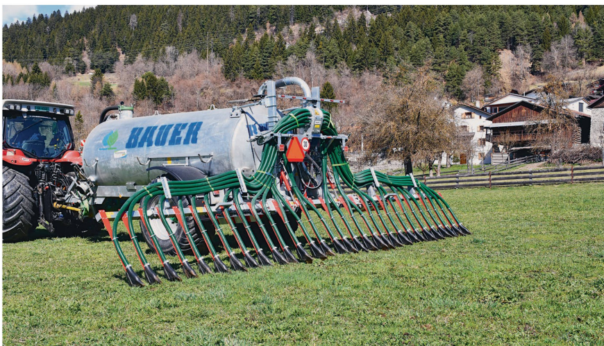
Bezogen auf den Futterertrag weist der Schleppschuh einen leichten Ertragsvorteil gegenüber anderen Techniken auf. Bild: R. Hunger
