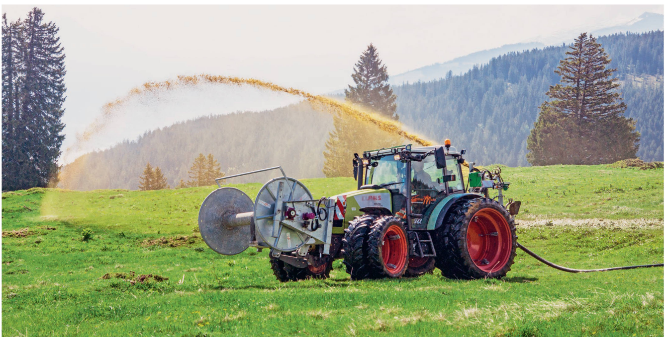
In Berg- und Hanglagen wird die Verschlauchung mit einer anderen Verteiltechnik eingesetzt.
