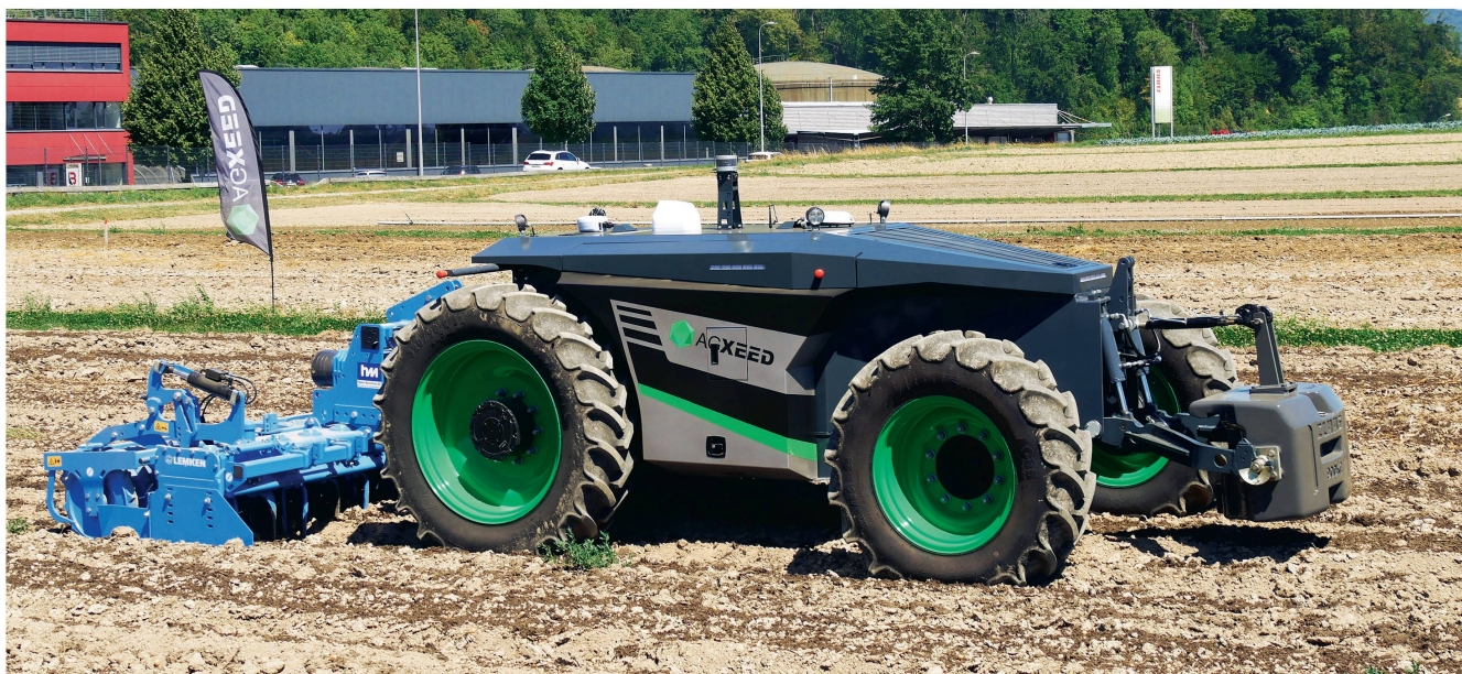
Bodenschonender Einsatz mit 3-Meter-Kreiselegge: Der «AgBot 2.055W4» ist die 4-Rad-Ausführung des holländischen Herstellers AgXeed und wiegt knapp über 3 Tonnen. Bilder: H. Röthlisberger
