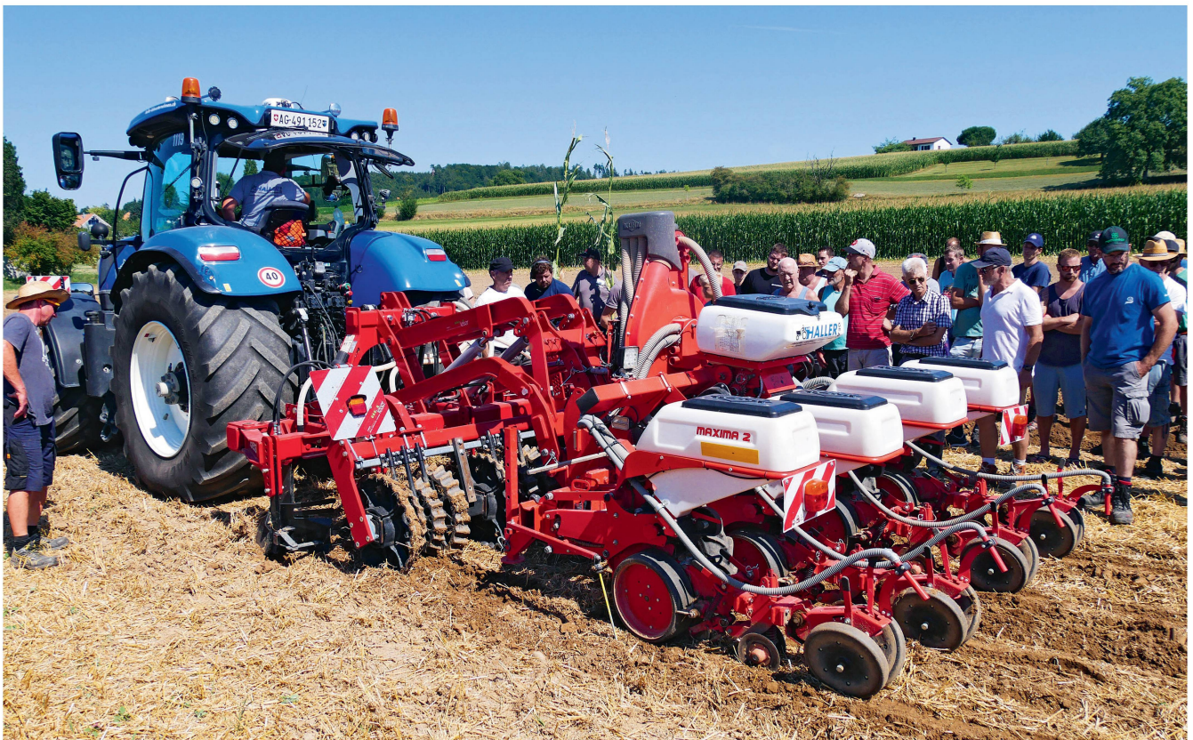
Die Damm-Säkombination mit aufgebauter Einzelkorn-Sämaschine bei der Vorführung Mitte August im Stoppelfeld. Mit dieser Kombination finden die Dammformung und Aussaat in einem Arbeitsgang statt. Bilder: H. Röthlisberger
