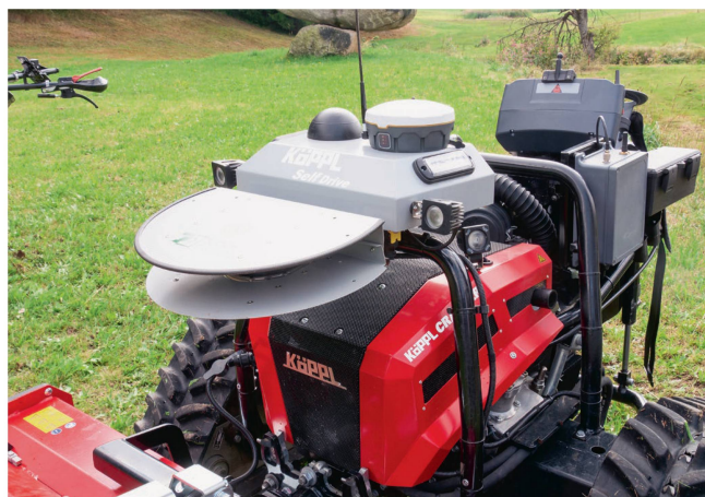
Die montierte Steuerungseinheit mit Funk- und GPS-RTK-Antenne sowie – geschützt – einem Laserscanner.
