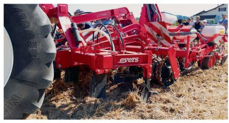
Nach dem Tiefenlockerer folgen der Dammformer und die Walze. Bei Bedarf kann eine Unterfussdüngung durchgeführt werden.
