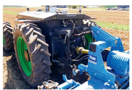
Die Hydraulikpumpe fördert 85 l/min Öl bei 210 bar Druck. Zudem gibt es bis zu 3 doppeltwirkende Proportional-Ventile und einen Hochspannungs-Anschluss.
