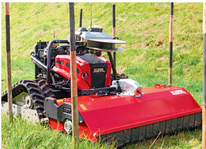
Das Anwendungspaket «RowCropPilot» arbeitet mit einem 3-D-Laserscanner und findet sich so in Reihenkulturen zurecht (hier im Einsatz mit dem «Crawler»).
