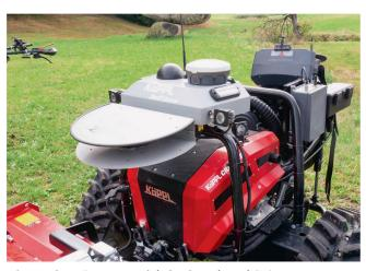
Die montierte Steuerungseinheit mit Funk- und GPS-RTK-Antenne sowie - geschützt - einem Laserscanner.
