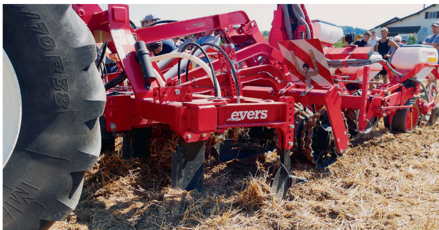
Nach dem Tiefenlockerer folgen der Dammbformer und die Walze. Bei Bedarf kann eine Unterfussdüngung durchgeführt werden.
