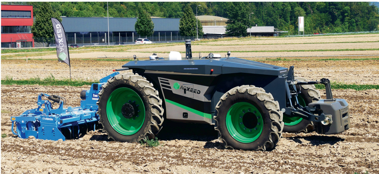
Bodenschonender Einsatz mit 3-Meter-Kreiselegge: Der «AgBot 2.055W4» ist die 4-Rad-Ausführung des holländischen Herstellers AgXeed und wiegt knapp über 3 Tonnen. Bilder: H. Röthlisberger
