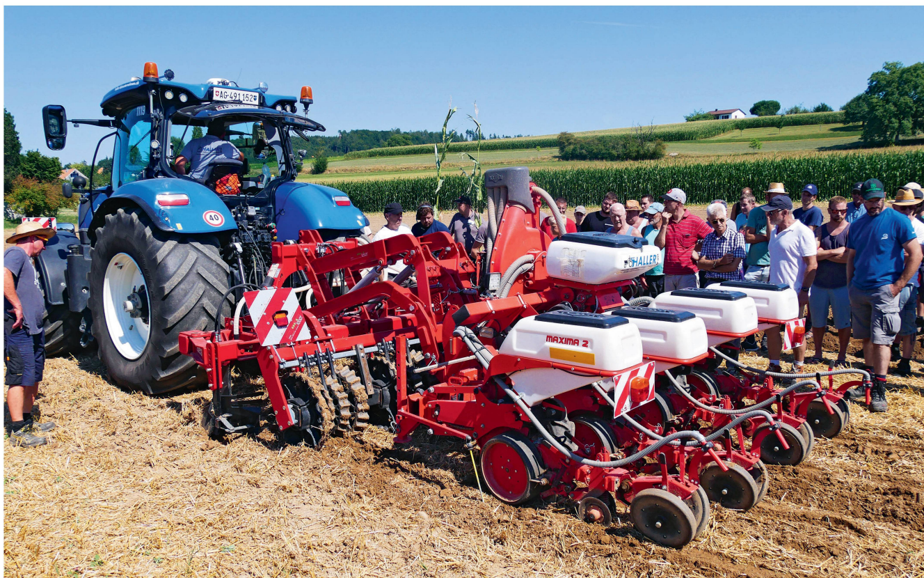
Die Damm-Säkombination mit aufgebauter Einzelkorn-Sämaschine bei der Vorführung Mitte August im Stoppelfeld. Mit dieser Kombination finden die Dammformung und Aussaat in einem Arbeitsgang statt. Bilder: H. Röthlisberger
