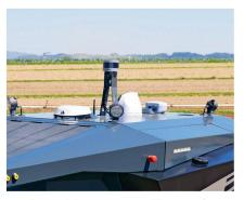
Für die Präzision sorgen Satellitenempfänger und RTK-Korrektur. Ein Lidar-Sensor ist für die Umfelderfassung zuständig
