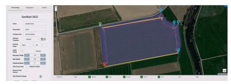
Über das Planungsportal werden beispielsweise die Felder, die Aufgaben für den Roboter sowie der Maschinenpark mit allen Parametern der Anbaugeräte verwaltet.
