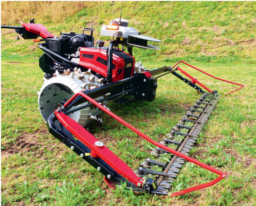
Dieser Einachser «Gekko» von Köppl mit Portal-Messerbalken kann dank dem System «SelfDrive» nun auch autonom unterwegs sein. Bilder: R. Engeler
