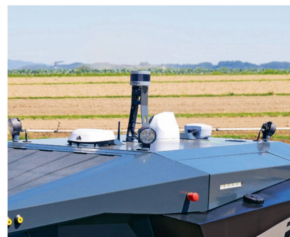
Für die Präzision sorgen Satellitenempfänger und RTK-Korrektur. Ein Lidar-Sensor ist für die Umfelderkennung zuständig
