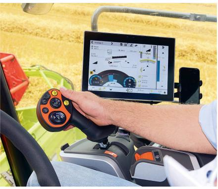
Halb- bis vollautomatische Assistenzsysteme unterstützen die Bedienperson und sollen so zu einem besseren und effizienteren Druschergebnis führen.
