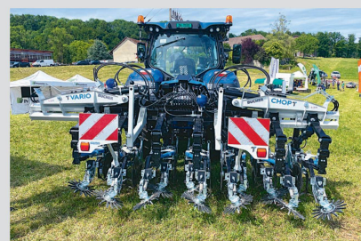
Das Hackgerät «VarioChop» von Samo bietet viele Möglichkeiten zur werkzeuglosen Einstellung.
