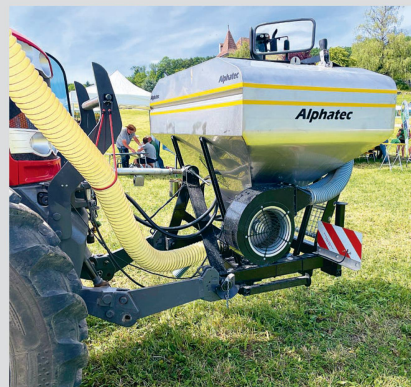
Mit diesem Gerät wird der für die Aussaat oder bei der Unkrautbekämpfung auszubringende Dünger transportiert.
