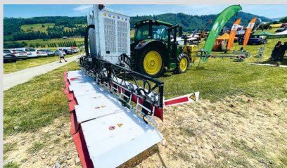
Die elektrische Krautvernichtung wird nun von Agroline in Form einer Dienstleistung mit diesem Gerät von crop.zone mit einem 9 m breiten Spritzgestänge angeboten.
