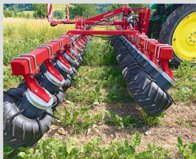
Der «Weedpuller» wird derzeit von Agroscope getestet und soll den Produzenten helfen, ihre Zuckerrüben-Parzellen maschinell zu jäten.
