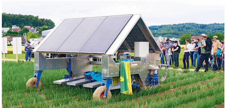
Mit vier Liegeplätzen ausgestattet ist das Solar-Jätmobil der Firma De Jong Machines aus Holland. Bilder: H. Röthlisberger
