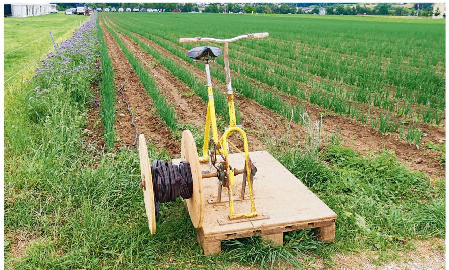
Mit dem alten Velo und mit der an die Vorderachse angebaute Haspel können Tropfbewässerungsschläuche mit eigener Muskelkraft aufgerollt werden.
