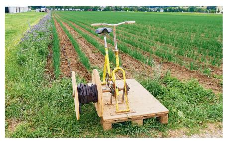
Mit dem alten Velo und mit der an die Vorderachse angebauten Haspel können Tropfbewässerungsschläuche mit eigener Muskelkraft aufgerollt werden.
