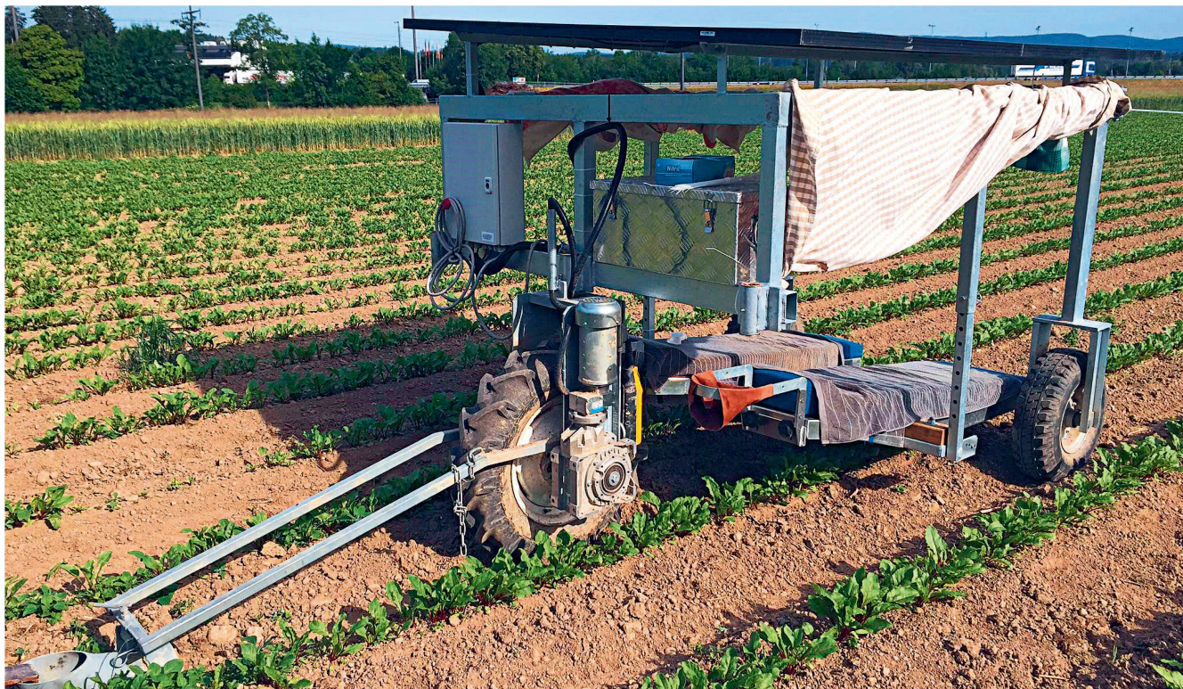
Schweizer Eigenbau-Entwicklung: das Drei-Rad-Jätmobil mit Solarantrieb und zwei Liegeplätzen. Bild: Daniel Steiner
