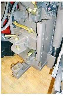
Piton-Fix mit ringförmiger Zugöse.
