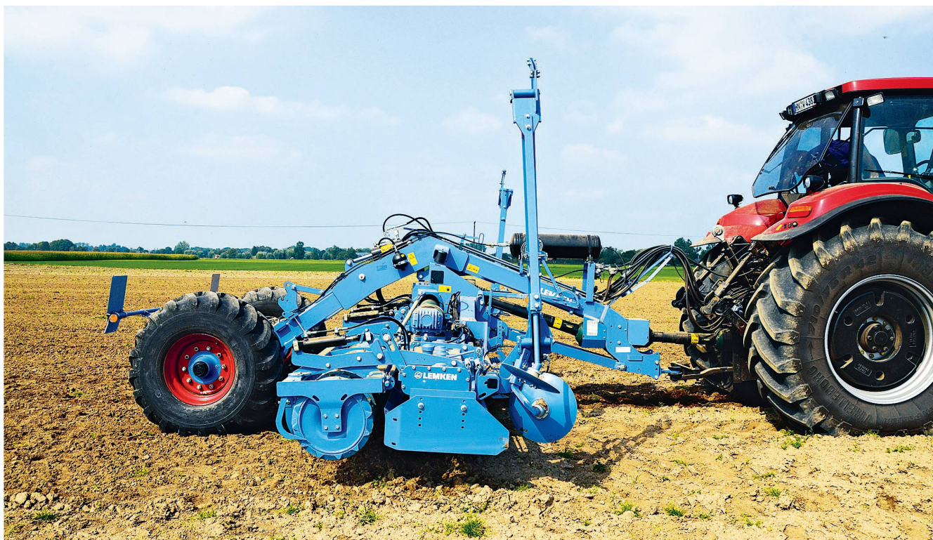
Mit einem Zugpendel an den Traktor angehängtes Gerät. Bilder: Walterscheid
