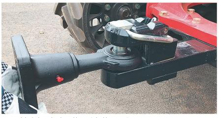
Zugpendel mit doppelt schwenkbarer Gelenklagerzugöse.
