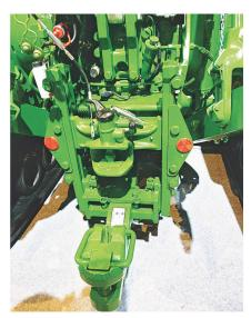
Zugpendel am Heck eines John-Deere-Traktors
