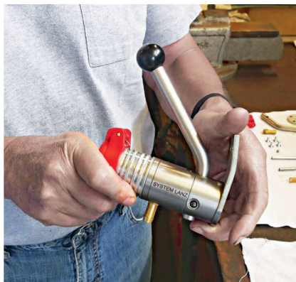
Der Druckentlaster «System Lanz» mit dem doppelwirkenden Hebel.
