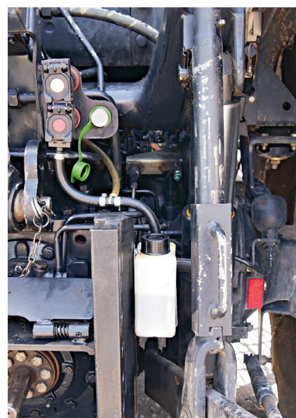
Das Restöl fliesst in einen Behälter. Hier in diesem Fall via T-Stück in den schon vorhandenen Leckölbehälter des Traktors.
