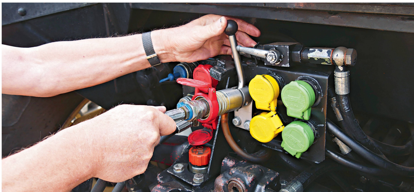
Der Druckentlaster ist an diesem Traktor gleich neben den Hydraulikanschlüssen des Traktors montiert. Mit dem Hebel wird der Druckentlastungsvorgang vorgenommen. Bilder: H. Röthlisberger
