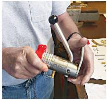
Der Druckentlaster «System Lanz» mit dem doppeltwirkenden Hebel.
