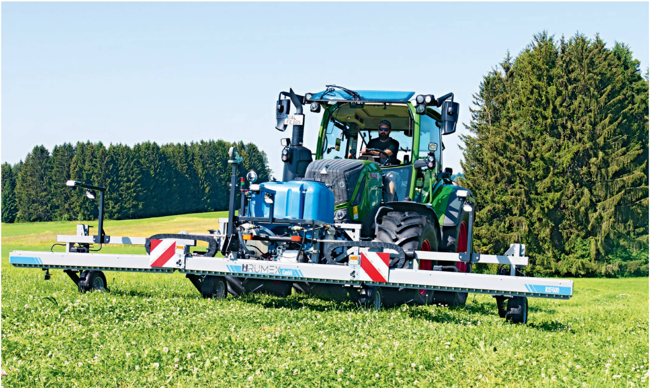
Das an der Front angebaute Gerät Rumex «RXF 600», das Blacken selektiv bekämpft, wiegt mit gefüllten Tanks rund 1 t. Bilder: R. Engeler
