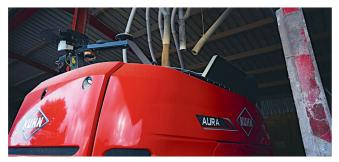
Komponenten wie Kraftfutter und Mineralstoffe werden über Befüllschnecken von oben dem Behälter beigegeben.
