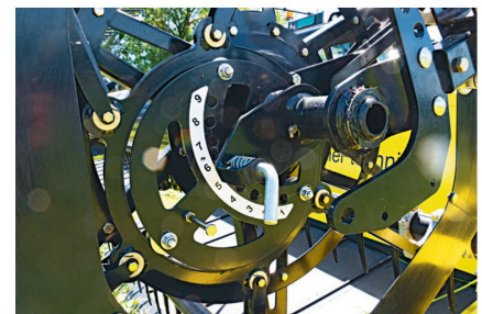
Der wichtige Eingriffswinkel der Haspelzinken kann in neun Stufen händisch verstellt werden.
