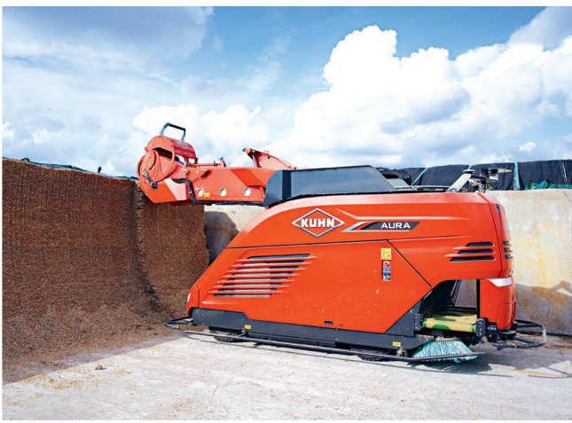
Der Fräskopf kommt mit allen Silagearten, aber auch mit Futter mit hohem Raufutteranteil zurecht.
