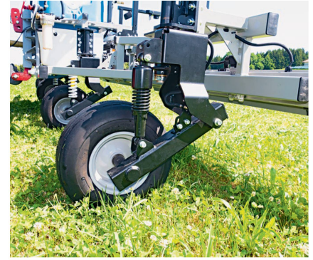
Der Spritzbalken ist schwimmend gelagert und die Tasträder sind gefedert, so dass Vibrationen minimiert werden.
