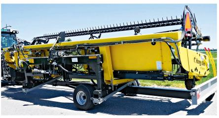
Für den Strassentransport wird das Schneidwerk auf einen Transportwagen verladen.
