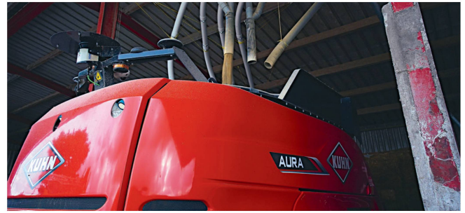
Komponenten wie Kraftfutter und Mineralstoffe werden über Befüllschnecken von oben dem Behälter beigegeben.
