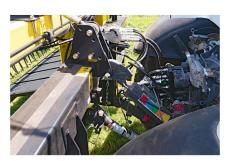
Das Gerät ist hier am Heck-Dreipunkt angebaut und wird mit einem Valtra «N174» mit Rückfahreinrichtung eingesetzt.
