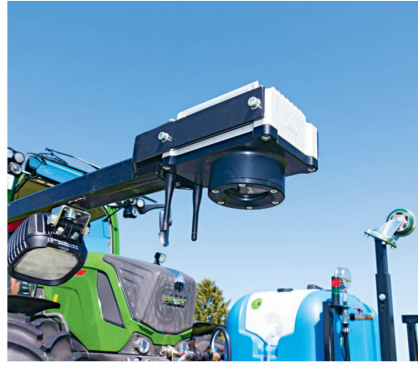
Mit solchen Hightech-Kameras wird die zu bearbeitende Fläche gescannt. Allfällige Schadpflanzen werden sofort detektiert.
