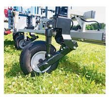
Der Spritzbalken ist schwimmend gelagert und die Tasträder sind gefedert, so dass Vibrationen minimiert werden.
