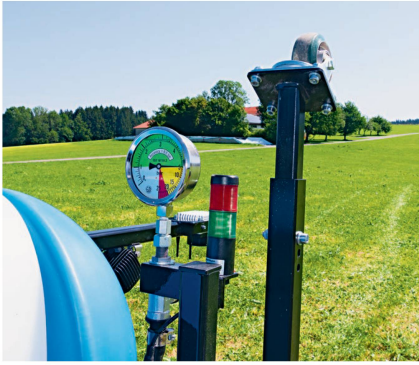
Der Zeiger auf dem Manometer und die grüne Leuchte weisen auf die Einsatzbereitschaft der Spritze hin.
