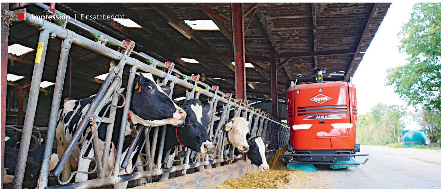
Der Austrag beim «Aura» erfolgt über ein Querförderband nach links oder rechts. Die Bürsten dienen dem Futterschieben und der Reinigung.
