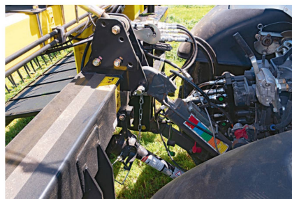
Das Gerät ist hier am Heck-Dreipunkt angebaut und wird mit einem Valtra «N174» mit Rückfahreinrichtung eingesetzt.
