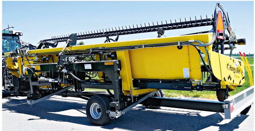
Für den Strassentransport wird das Schneidwerk auf einen Transportwagen verladen.
