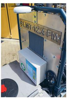
Ein GPS-Empfänger mit der notwendigen Steuereinheit befindet sich oberhalb des Spritzbrühentanks.
