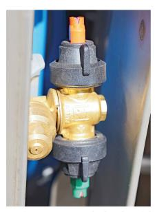
Ein Düsen-Paar von Arag; durch Drehen wird eine der Düsen in Betrieb genommen oder beide werden ausgeschaltet.
