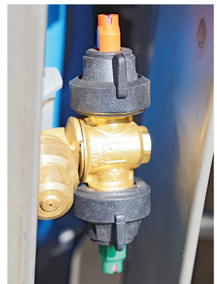
Ein Düsen-Paar von Arag; durch Drehen wird eine der Düsen in Betrieb genommen oder beide werden ausgeschaltet.
