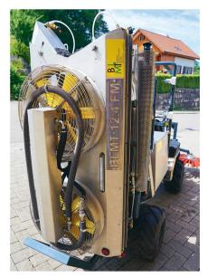
Das Doppelflügel-Axial-Querstrom-Gebläse «G2» von Mitterer.
