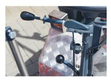
Der obere Hebel der Fahrschaltung ist für den hydraulischen Frontantrieb, der untere Hebel dient für die mechanische Hinterachse.
