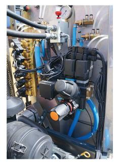
Die Luftmengensteuerung des Gebläses wird oben und unten mit dem roten Drehrad verstellt.
