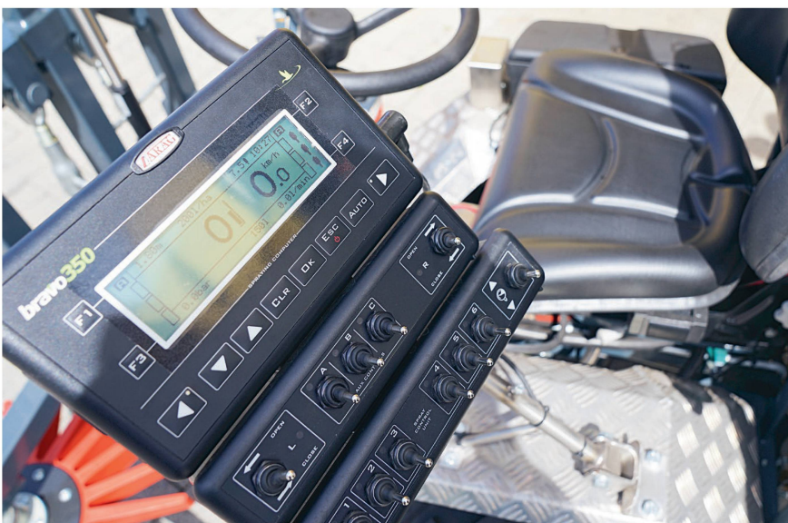
Der Arag-«Bravo350»-Bordcomputer für zweimal drei Sektionen wird von Andreas Baumgartner je nach Rebbeg und Kundenwunsch für eine genaue Ausbringung der Spritzbrühe programmiert.
