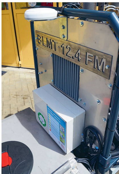
Ein GPS-Empfänger mit der notwendigen Steuereinheit befindet sich oberhalb des Spritzbrühentanks.
