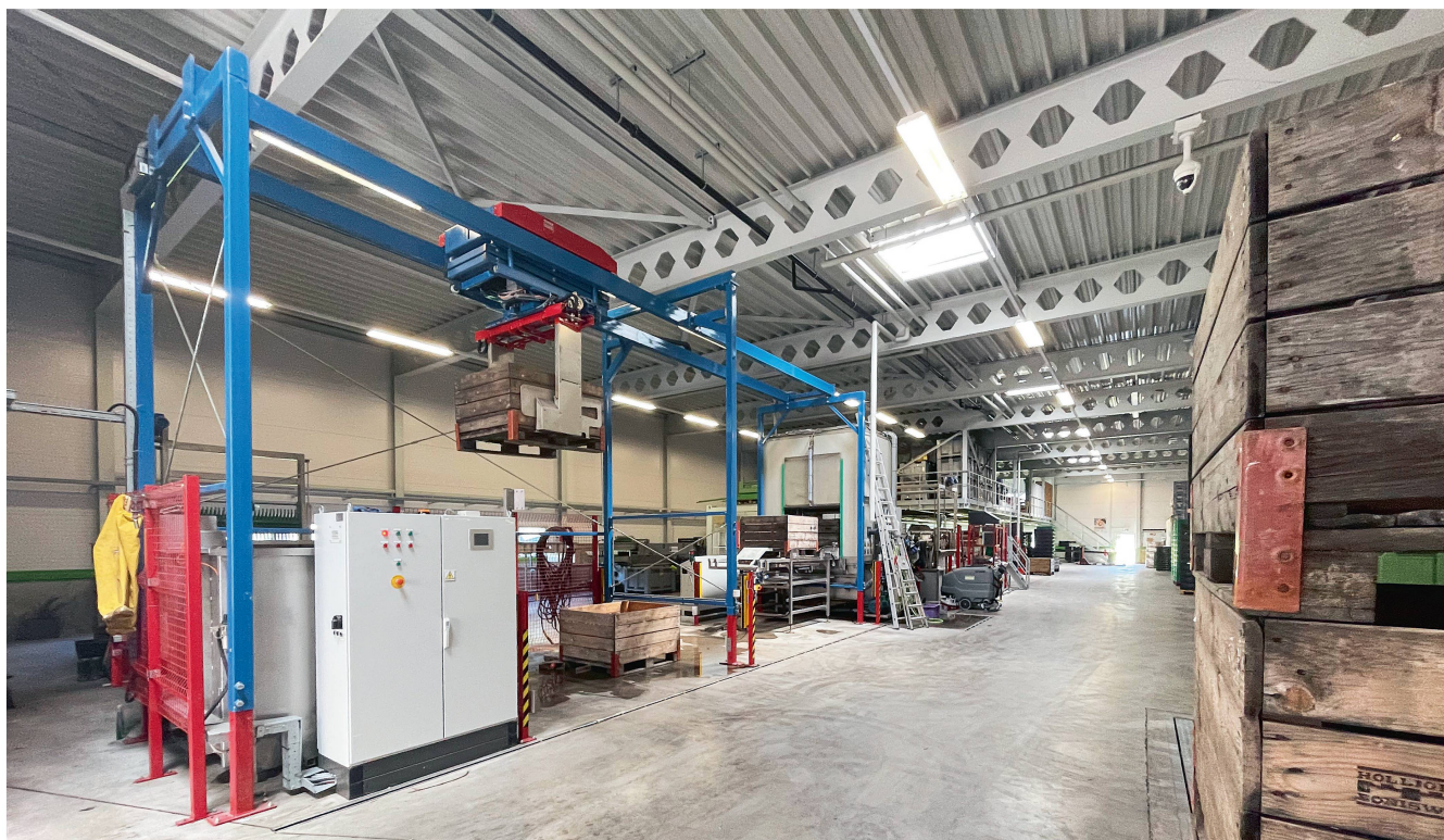
Die Kalibrier- und Sortiermaschine «CombiSort» von Hersteller Greefa aus Holland sortiert auf dem Walliser Obstbaubetrieb Moret Fruits SA jährlich rund 2000 Tonnen Äpfel und Birnen. Bilder: M. Schubnel
