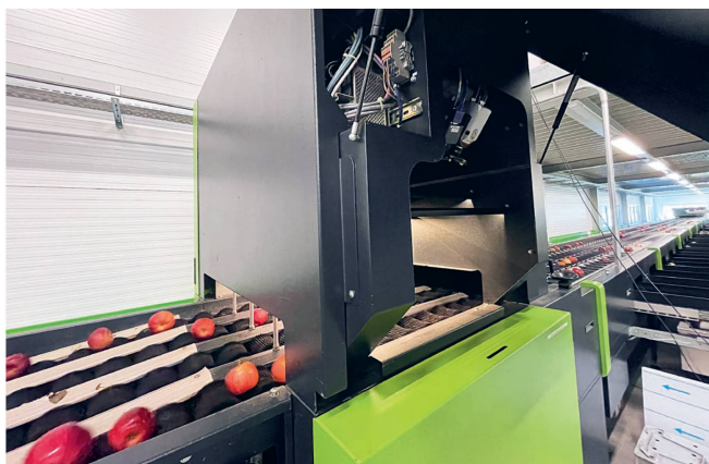
In der Dunkelkammer analysieren hochauflösende Kameras das äussere Erscheinungsbild der Äpfel und identifizieren mögliche Mängel sowie geometrische Unregelmässigkeiten.
