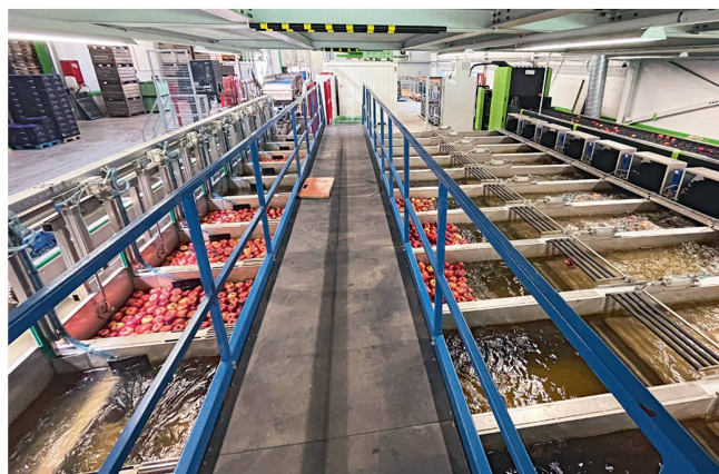
Die Äpfel fallen je nach Grösse und Qualität durch die Schwerkraft in eine der 16 Chargenbildungs-Zonen. Die Sortiermaschine findet im Durchschnitt 7 bis 8 Prozent Mängel.
