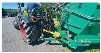
Mit der an den Unterlenkern befestigten Knicklenkeranhängung und der Weitwinkelgelenkwelle ist der Streuer sehr wendig einsetzbar.
