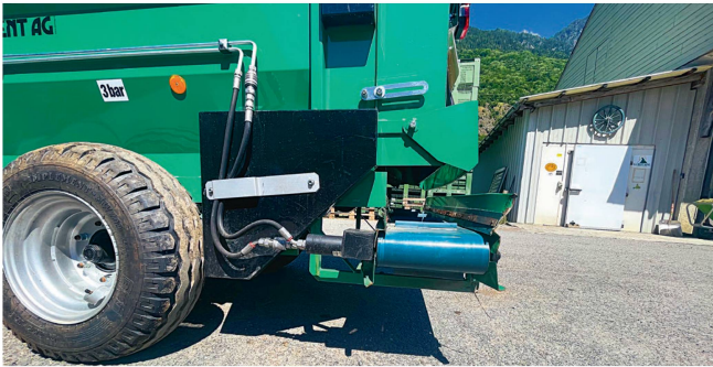
Das 25 cm breite Querförderband erlaubt das gleichmässige und gezielte Verteilen in der Reihe.
