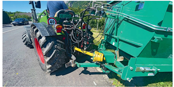
Mit der an den Unterlenkern befestigten Knicklenkeranhängung und der Weitwinkelgelenkwelle ist der Streuer sehr wendig einsetzbar.
