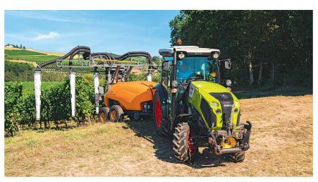
Klein, aber stark: Obst- und Weinbautraktoren sind kleine Kraftpakete mit Motorleistungen von 37 kW bis 79 kW (50 bis 108 PS). Bild: Claas
