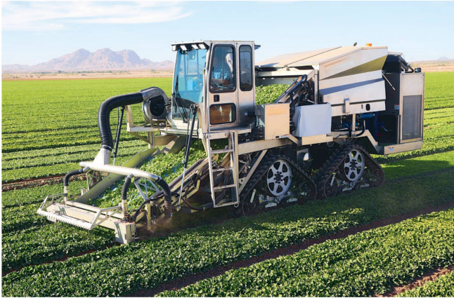
Um die Kundenanforderungen zu erfüllen, wurde diese selbstfahrende Spinat-Erntemaschine komplett aus Edelstahl gebaut.
