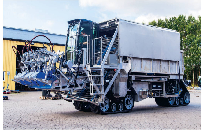
Ebenso besteht diese Erntemaschine für Salat komplett aus Edelstahl. Bilder: Grimme/Spudnik
