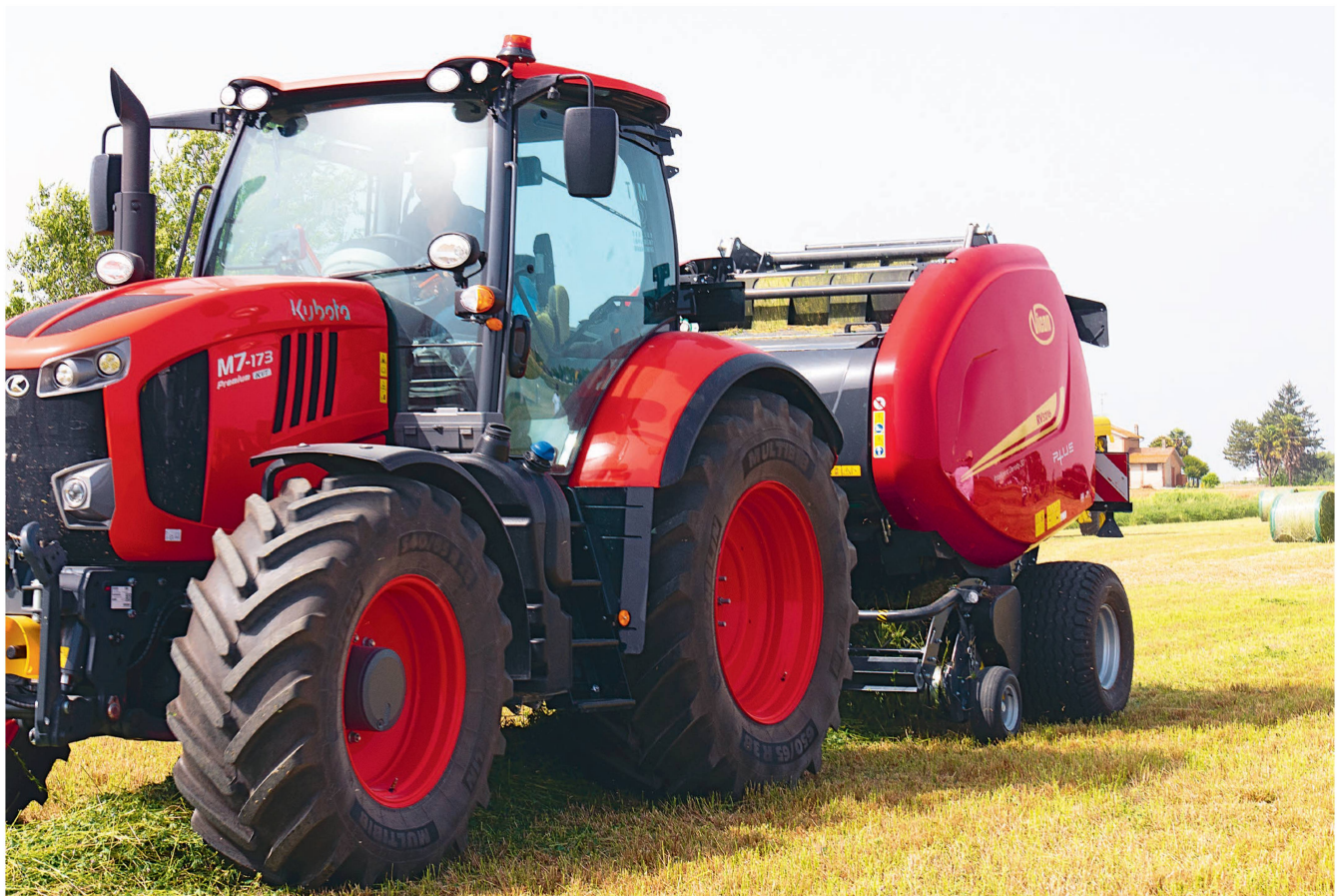
Maschine führt Traktor oder «Tractor Implement Management»: Kverneland hat dieses System nun erstmals bei Rundballenpressen umgesetzt. Bilder: R. Engeler
