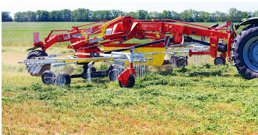
Mit dem Mittenschwader «Top 882 C» lassen sich bis zu 2,60 m breite Schwade formen.
