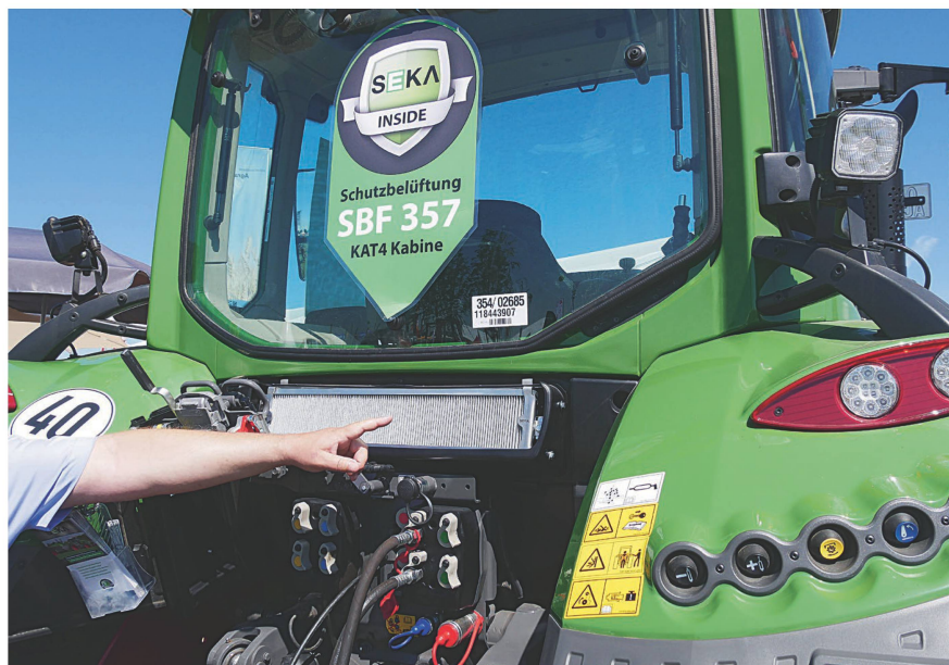
Die neue «SBF 357» kann bei drei Fendt-Baureihen platzsparend in die Kabine integriert werden. Hier der Filter ohne Schutzabdeckung. Bild: röt
