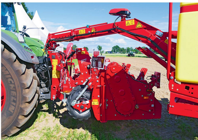
An das separate Hubwerk lassen sich alle gängigen Bodenbearbeitungsgeräte kuppeln. Bilder: H. Röthlisberger
