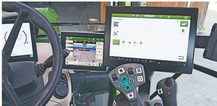
Benötigt wird das John-Deere-Display «Gen 4 Universal» (links neben dem grossen Fendt-«ONE»-Display) sowie ein «StarFire»-Empfänger. Zudem muss der Traktor TIM-fähig sein.
