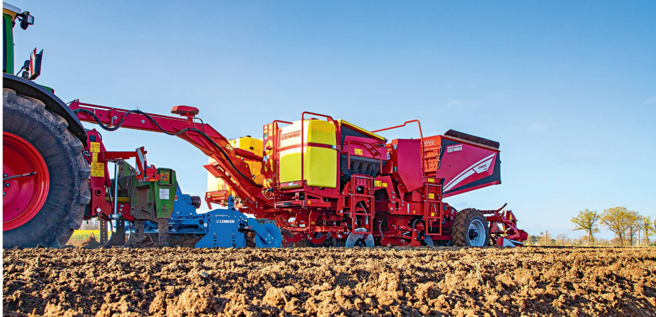
Die «Prios 440» mit der Option Schwanenhals-Deichsel ist das neue Topmodell im Legemaschinen-Programm von Grimme. Die Legemaschine ist etwas über 10 Meter lang, wenn das Bodenbearbeitungsgerät komplett unter dem Schwanenhals durchschwenken kann. Bild: Grimme
