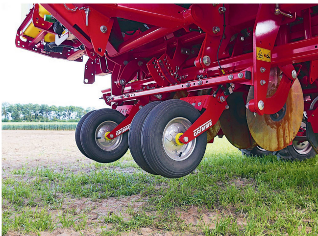
Zwei Doppeltasträder und zwei Ultraschallsensoren sorgen für die exakte Tiefenführung.
