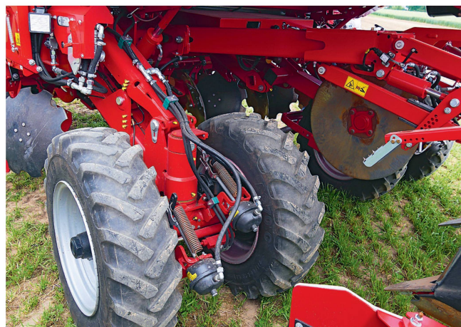
Optional gibt es teleskopierbare Achsen. Mit diesen lässt sich die Transportbreite von 3,30 auf unter 3 Meter reduzieren.
