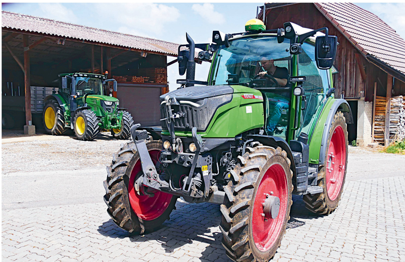
Mit «TIM»-Aktivierung kann das Lenksystem «AutoTrac» von John Deere nun einfacher auf Traktoren anderer Marken genutzt werden. Lenkrad- und Controller-Komponenten werden keine mehr benötigt. Bilder: H. Röthlisberger
