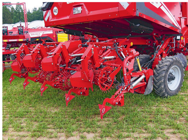
Eine Kombination aus Platten und Gitterrollen erzeugt stabile, glatte Dammlanken sowie offenporige Dammkronen.
