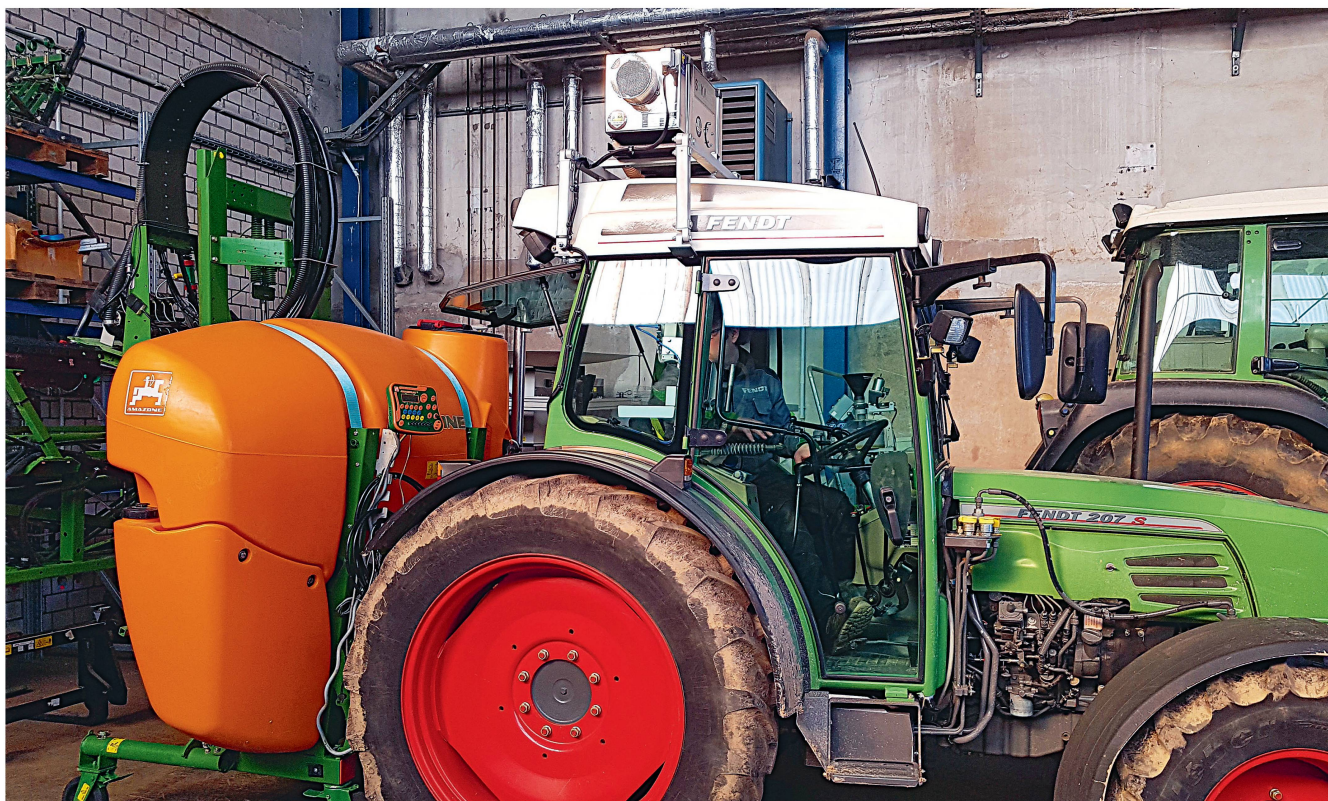
Die Schutzbelüftungsanlage «SBT 50» wird aussen am Traktor montiert. An diesem Fendt «207 S» auf dem Dach der Kabine. Bilder: Seka
