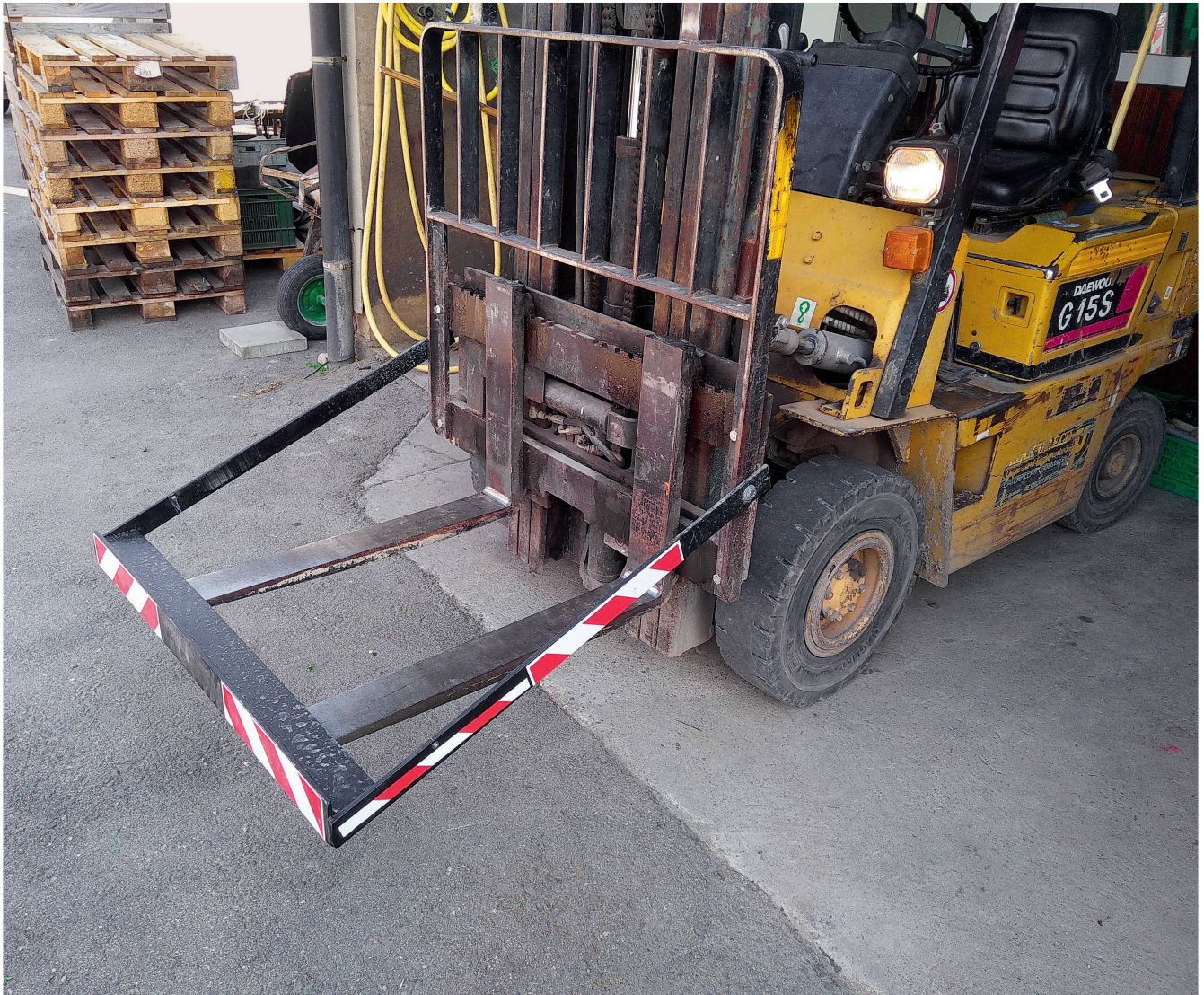
Eine mögliche Lösung einer Stapler-Gabelsicherung. Der Schutzbügel kann einfach hoch- und runtergeklappt werden. Wird der Bügel aufgeklappt, kann er oben mit zwei kleinen Verschlüssen befestigt werden. M. Etter
