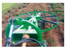
Der kreiselnde Striegel, der auf einem Schwader basiert, kann für das Striegeln in Reihenkulturen eingesetzt werden.
