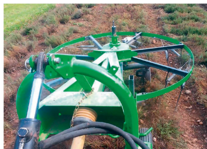
Der kreiselnde Striegel, der auf einem Schwader basiert, kann für das Striegeln in Reihenkulturen eingesetzt werden.
