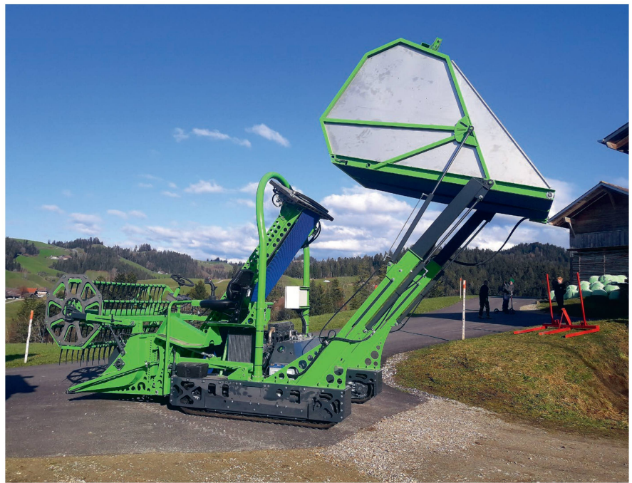
Der Kräutervollernter mit Raupenfahrwerk, Haspel-Mähwerk, Förderband und Überladebunker wird in dieser Saison erstmals eingesetzt.
