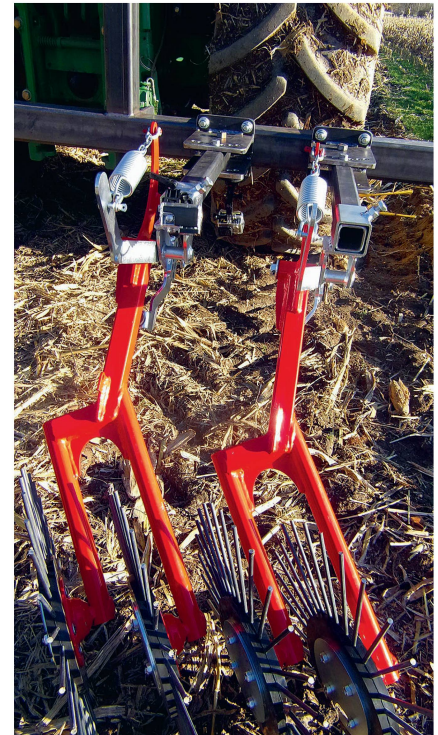
Die rotierenden, sternförmigen Werkzeuge erfassen die nach der Ernte am Boden liegenden Stoppeln und richten sie vorgängig auf, damit der Mulcher sie aufnehmen kann.
