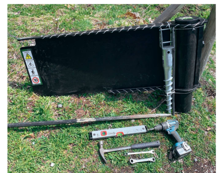
Das für die Montage des «Flow-Gates» benötigte Material mit der Erdschraube.
