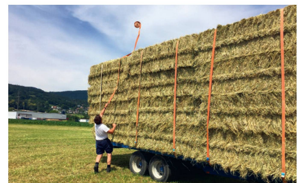
Grossballentransporte müssen korrekt und mit ausreichenden Zurrmitteln gesichert werden.
