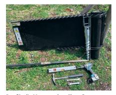
Das für die Montage des «Flow-Gates» benötigte Material mit der Erdschraube.
