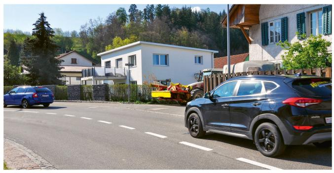
Ab 3 Meter vorderem Überhang sind Seitenblickspiegel und ab 4 Meter ein geprüftes Kamera-Monitor-System sowie vorne auf dem Gerät ein gelbes Gefahrenlicht erforderlich. Achslast und Reifentragkraft müssen eingehalten werden. Bilder: BUL
