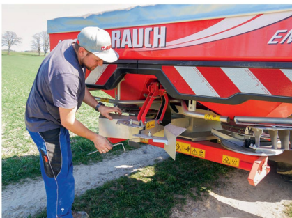
Die Grenzstreu-einrichtung «GSE» (links) ermöglicht Grenzstreuen direkt an der Feldgrenze. Mit dem «Telimat» (rechts) lässt sich aus der ersten Fahrgasse rand- und grenzstreuen.
