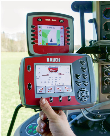
Das «Quantron A»-Terminal steuert unter anderem die «EMC»-Dosierautomatik, die Teilbreiten und regelt die Durchflussmenge nach Fahrgeschwindigkeit.
