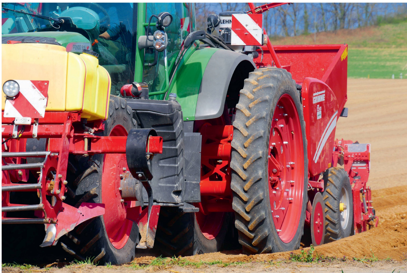
Das ausgefahrne Doppelrad von Becklönne im praktischen Einsatz beim Legen von Kartoffeln. Bilder: H. Röthlisberger und R. Engeler
