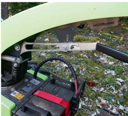
Holmhöhe und -neigung sind mit zwei Hebeln schnell verstellbar.
