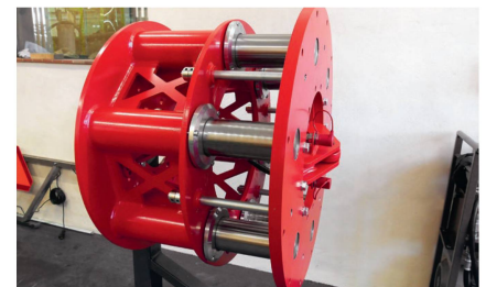
Sechs Wellen für die Kraftübertragung respektive sechs Führungswellen verbinden das Innen- mit dem Aussenrad und sorgen für ein stossfreies Verschieben.
