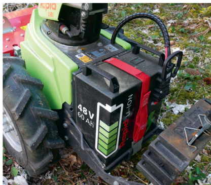
Als Energiequelle dienen solche 22 kg schweren Lithium-Ionen-Akkus.
