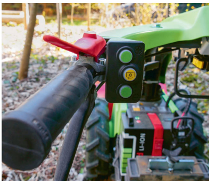
Seitlich des linken Holmgriffs sind die Druckknöpfe für die Zapfwellenbedienung.
