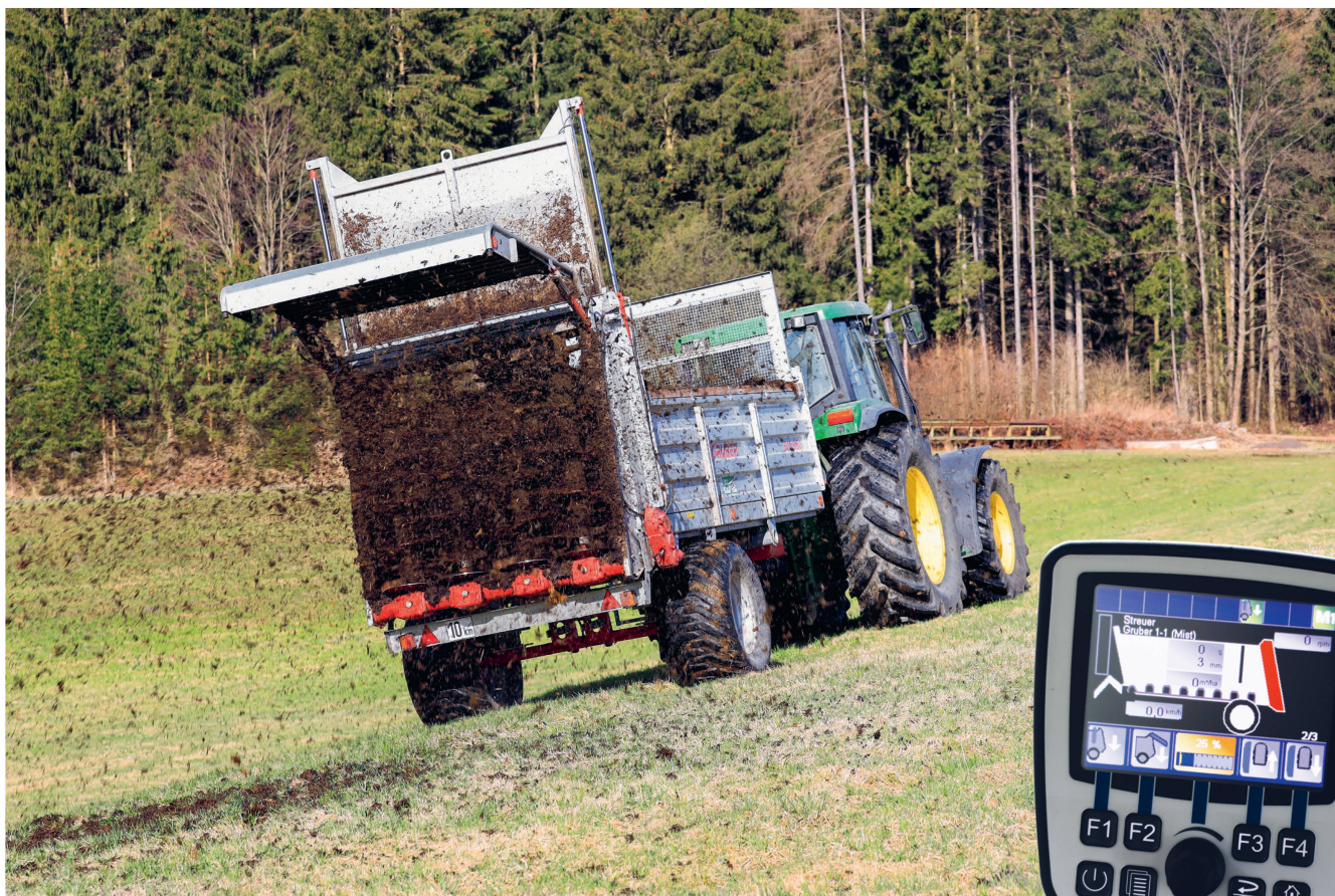
Dank der elektrohydraulischen Steuerung lässt sich der Mist mit diesem Streuer «SM 850» von Gruber fein und gleichmässig verteilen. Bilder: J. Paar
