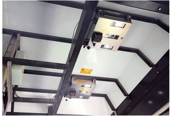
Die sechs hochauflösenden Kameras schiessen Fotos mit grosser Überlappung, so dass jede Pflanze mehrfach abgebildet wird.
