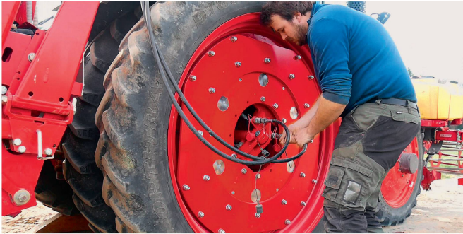
Von der Bordhydraulik des Traktors werden zwei Schläuche für den Verschiebevorgang angeschlossen.
