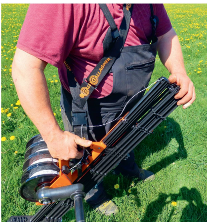
Mit dem optional erhältlichen Tragegurt kann man sogar freihändig und speditiver arbeiten.
