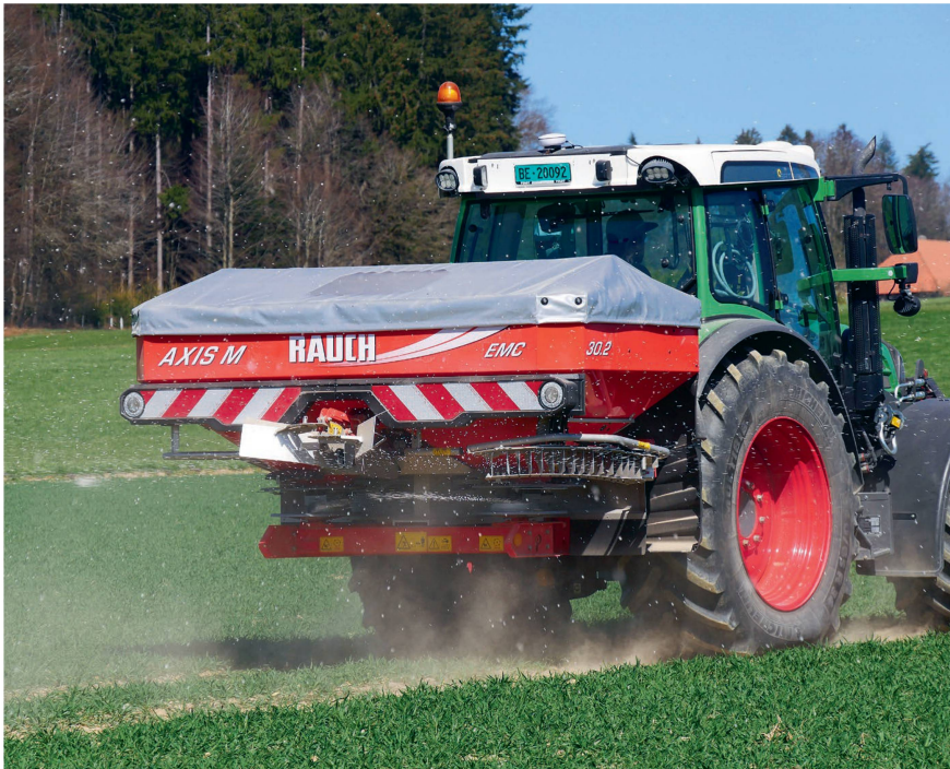
Der Düngestreuer «Axis M30.2 EMC» von Rauch mit der 8-fach-Teilbreitenschaltung «VariSpread Pro» im Einsatz in einem Weizenfeld. H. Röthlisberger
