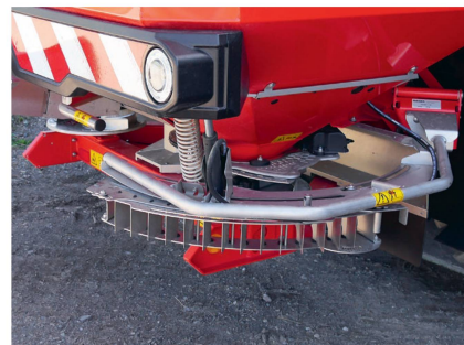
Die Grenzstreu-einrichtung «GSE» (links) ermöglicht Grenzstreuen direkt an der Feldgrenze. Mit dem «Telimat» (rechts) lässt sich aus der ersten Fahrgasse rand- und grenzstreuen.
