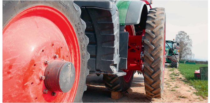
Für das Aus- und Einfahren des Doppelrads wird auf einen Holzkeil gefahren.
