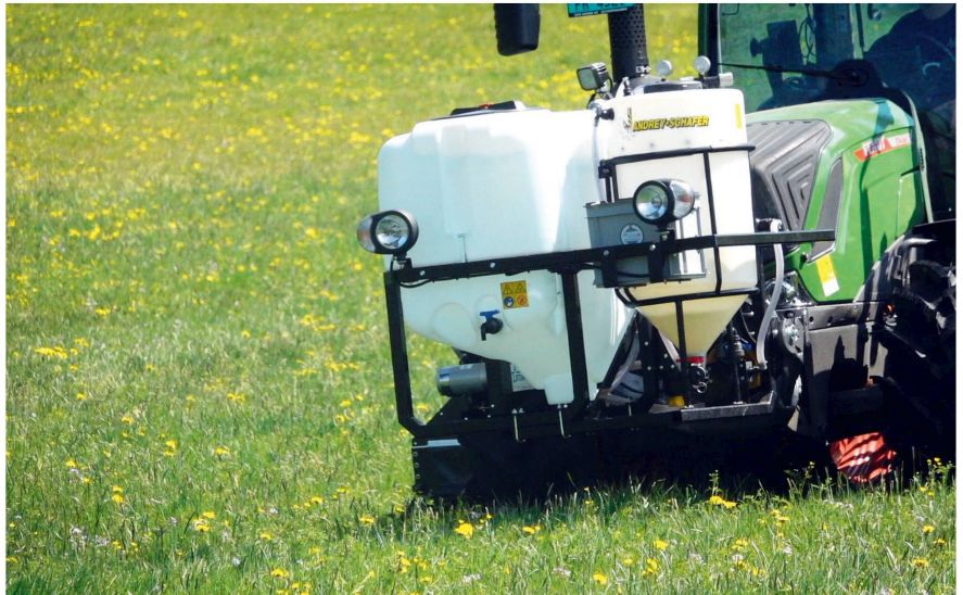
Die 600 l Frischwasser im Fronttank reichen für einen ganzen Arbeitstag aus.
