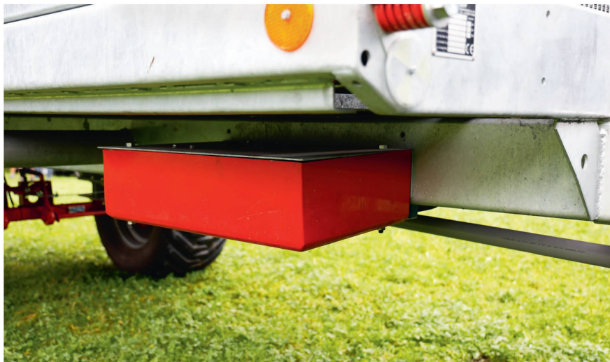
Der Steuerblock befindet sich geschützt rechts vorne unter dem Plateau.
