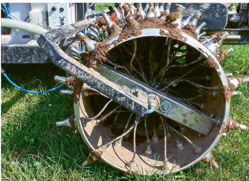
Der Flüssigkeitsaustritt erfolgt durch seitliche Öffnungen zum Zeitpunkt, in dem die «Stacheln» in den Boden einstechen.
