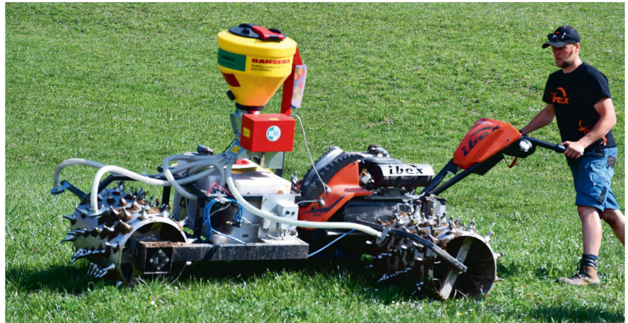
Injizieren statt säen. Die flüssige Pilz-Suspension wird mit dem Ibx «MMexit» in den Boden gebracht.
