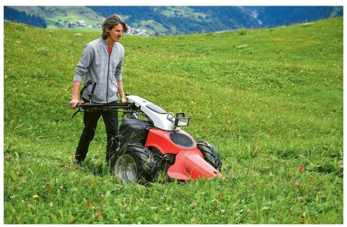
Gian Caduff mit einem auf «ePowerUnit» umgerüsteten Motormäher. Der elektrische Antrieb ermöglicht ein entspannteres Mähen ohne Abgase und mit weniger Lärm. Bilder: R. Hunger
