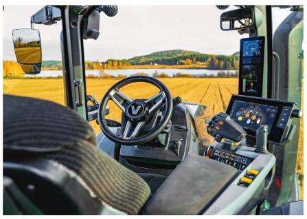
Neues Fahrgefühl in der Kabine eines Valtra «T255 Direct» mit neuen Displays an der «SmartTouch»-Armlehne und am A-Holm. Bild: Valtra
