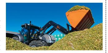
dem neuen, nach dem Blickfeld des Fahrers ausgerichteten Querträger werden auch Palettenzinken ausgezeichnet einsehbar. Bei grossen Traktoren wird die Sicht optional durch eine mittig aufgebaute Frontkamera sichergestellt. Dunkle Arbeitsbereiche können durch LED-Scheinwerfer an der Schwinge ausgeleuchtet werden.
