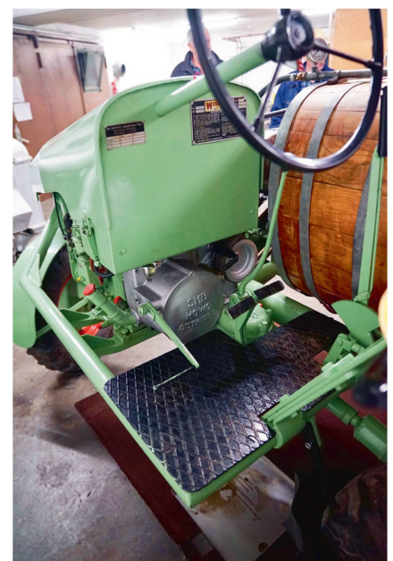
Die linksseitige Anordnung des Führerstandes beim Dreiradspritztraktor von Biefer.
