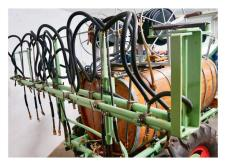
Der Spritzbalken misst ausgeklappt 6m; man beachte die zwei Hahnen am unteren Fassende.
