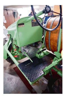
Die linksseitige Anordnung des Führerstandes beim Dreiradspritztraktor von Biefer.
